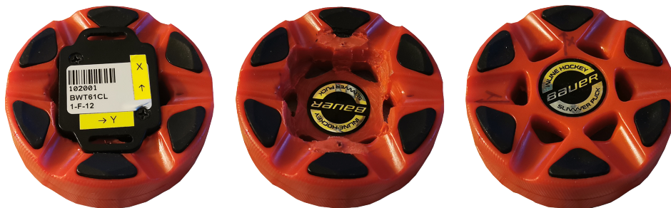
Obrázek 6.2: Návrh puku se senzorem
