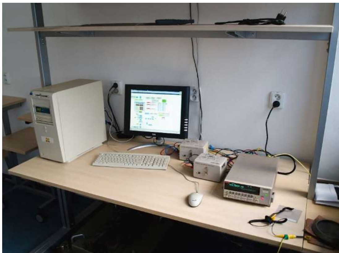
Obr. 3.3 Fotografie tříelektrodového měřicího systém spojený do KEITHLEY 6517A a řízen počítačem
