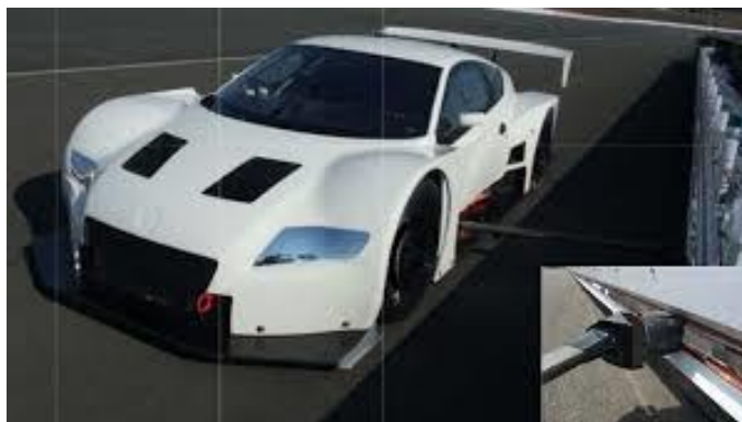
Obr. 5 Testovací vozidlo Honda nabíjené z boku [56]
