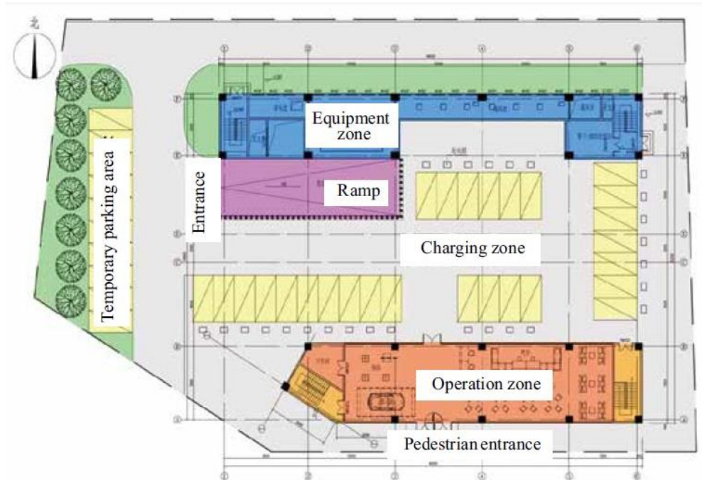
Obr. 19 Půdorys přízemního patra vícepodlažní nabíjecí stanice [42]
