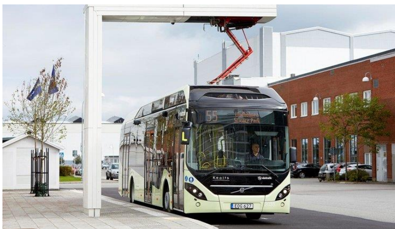
Obr. 3 Autobus Volvo 7900 v Göteborgu při nabíjení střešním sběračem [39]
