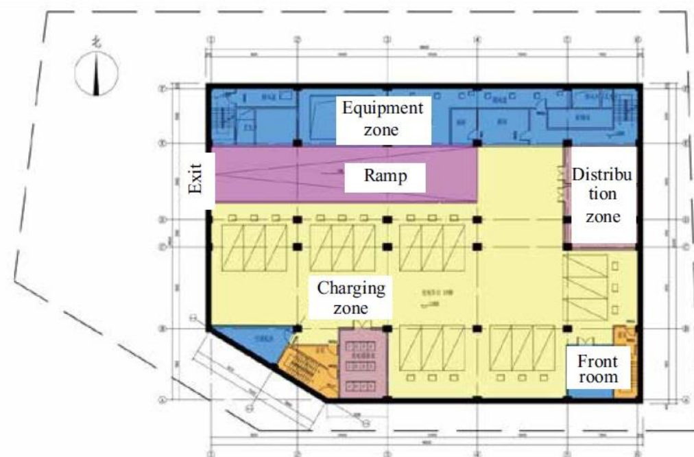
Obr. 20 Půdorys podzemního patra vícepodlažní nabíjecí stanice [42]
