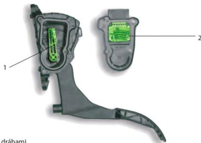
Obr. 2.2: Akcelerační pedál z vozu Škoda Fabia II [3]
