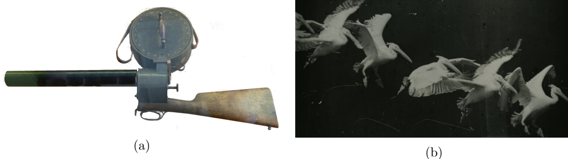
Obrázek 7: Mareyova fotografická puška (a) 6 a snímek pelíkána na ni zachycený (b) 7
