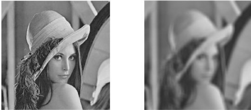
Obrázek 2.1: Příklad použití průměrového vyhlazování jádrem 21x21 [11]
