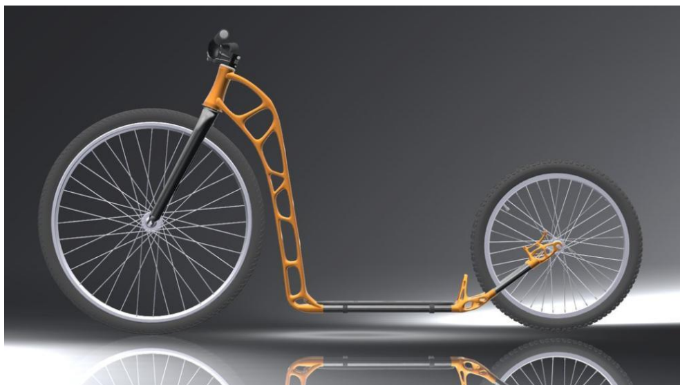
Obr. 6: Rám koloběžky z 3D tiskárny [2]
