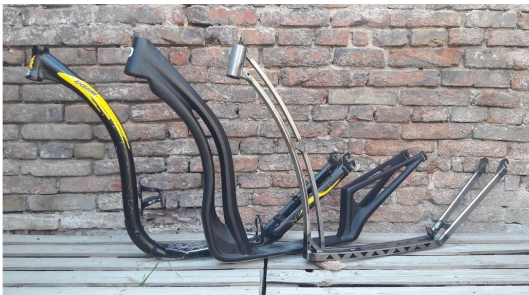
Obr. 7: (zleva) hliníkový rám Kickbike, karbonový rám IDEA STRNADEL a ocelový rám MIBO [17]
