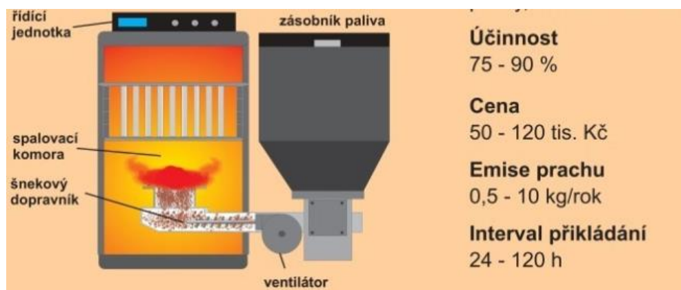
Obr. 9 – funkční schéma automatického kotle
