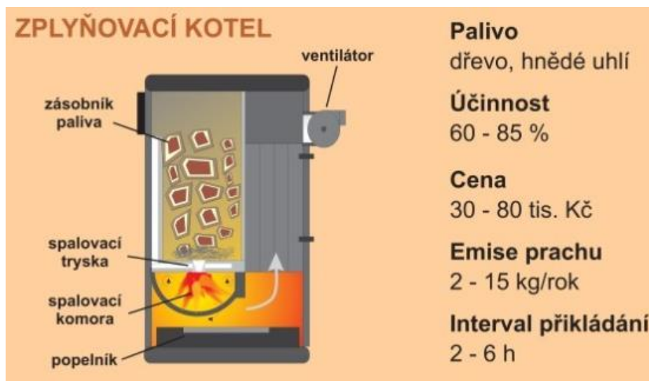
Obr. 8 – funkční schéma zplyňovacího kotle
