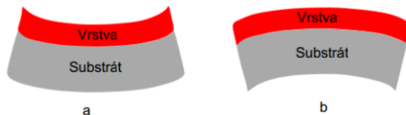
Obr. 4.5 Schématické znázornění působení: a – tlakového pnutí, b – tahového pnutí. Upraveno, převzato z [75].
