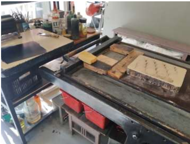
Obrázek 31 – kámen umístěný v kamenotiskařském lisu (vlastní foto)
