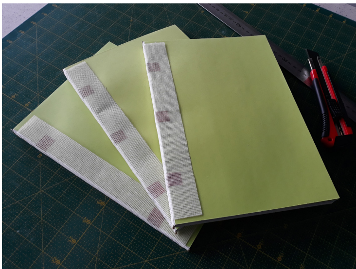
příloha 13 – Tvorba knihy: přilepení gázy a kapitálek, příprava škrobu, lisování zavěšených knih (vlastní foto)
