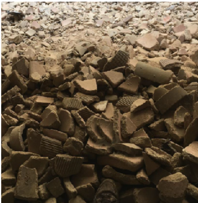
Fotka č.9 - chybné kusy z třemošné, materiál na stavbu
