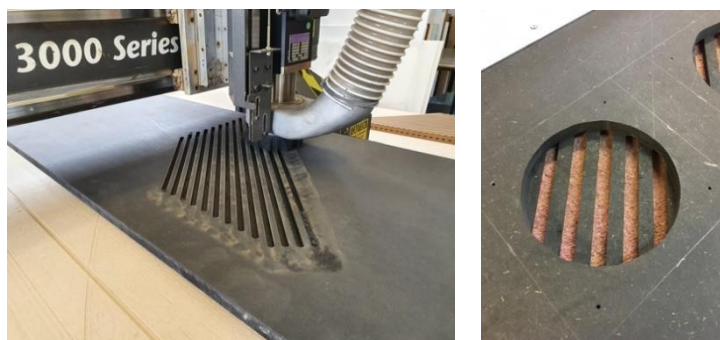
Obrázek č. 21 a 22 – frézování desek a vyříznutí otvorů pro reproduktory, archiv autora
