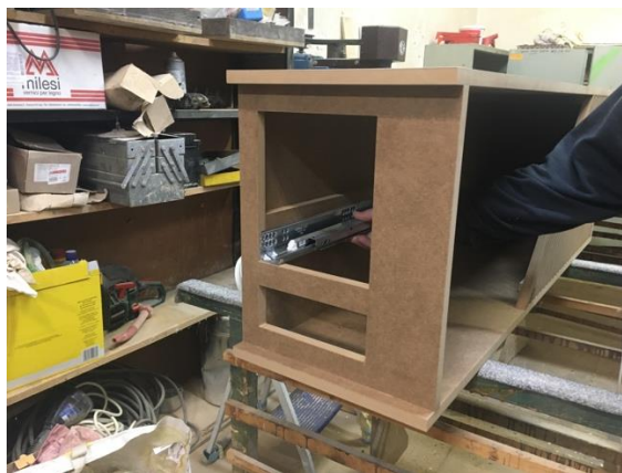
Obrázek č. 26 – pohled dovnitř na zdvojenou desku s panty a boční nosná deska s otvory pro zásuvky, archiv autora
