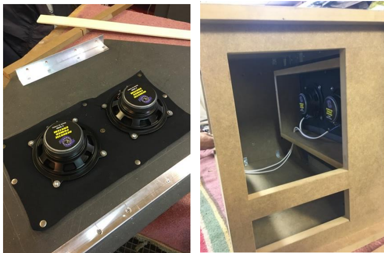
Obrázek č. 27 a 28 – připevnění reproduktorů na desku, reproduktory uvnitř skříňky, archiv autora
