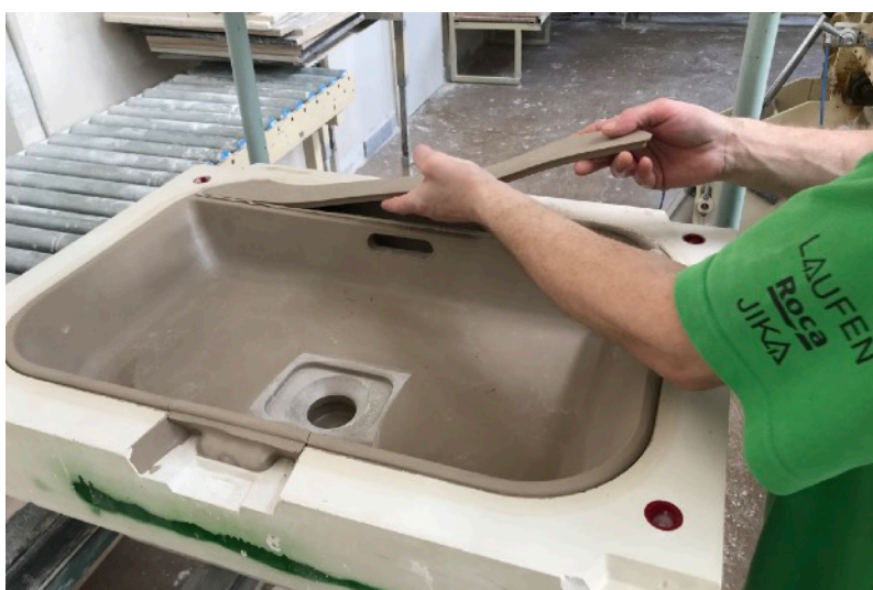
Přiložení lišty na cirkulační komoru
