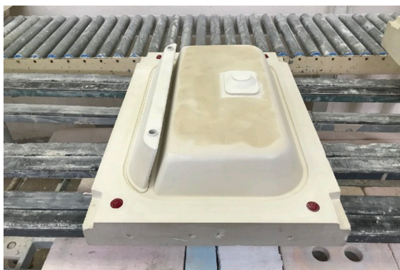
Ošetření pláště mastkem
