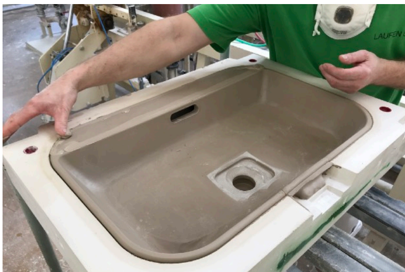
Nanášení druhé vrstvy sražené z důvodu zajištění kvalitního spoje
