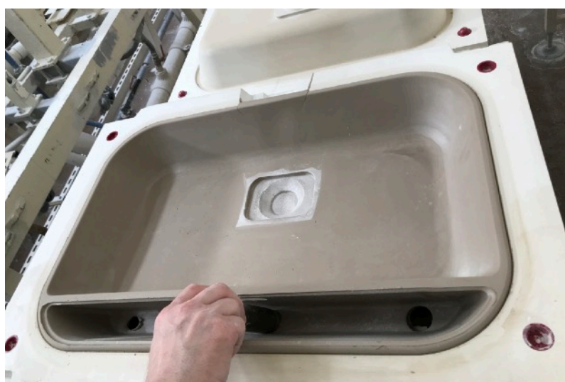
Vypichování otvorů do cirkulační komory
