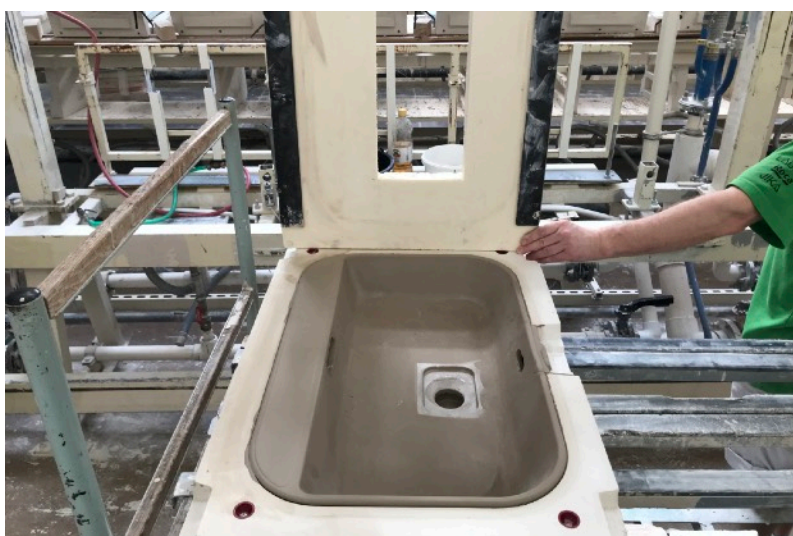
Přikládání polystyrenové desky na formu umyvadla
