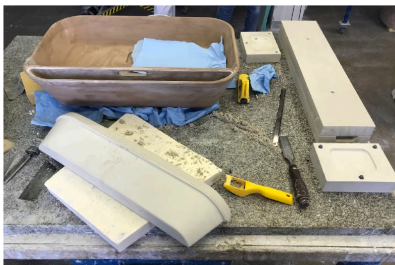
Výroba a opracování klínu tvořícího cirkulační komoru
