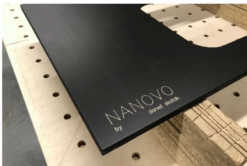
Natřená překližka s vyfrézovaným logem
