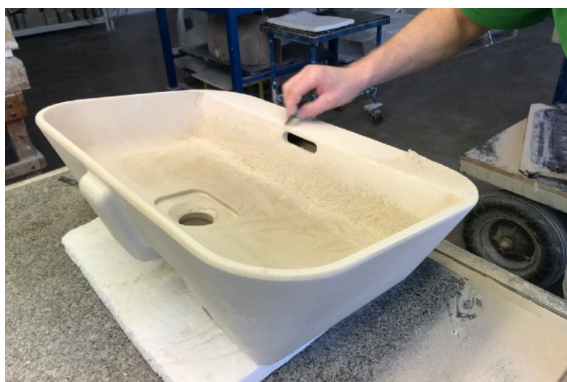
Finální začištění veškerých nerovností
