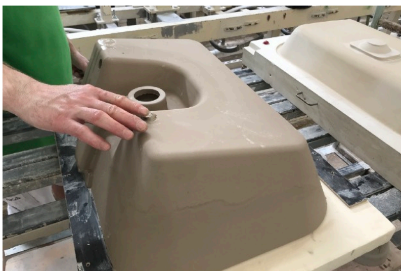
Začišťování otvorů vytvořených při spuštění
