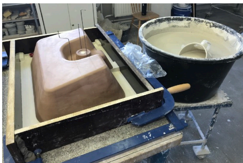
Příprava bednění a sádry
