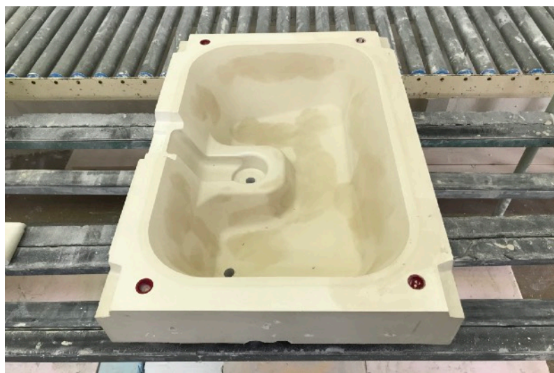
Ošetření pláště mastkem
