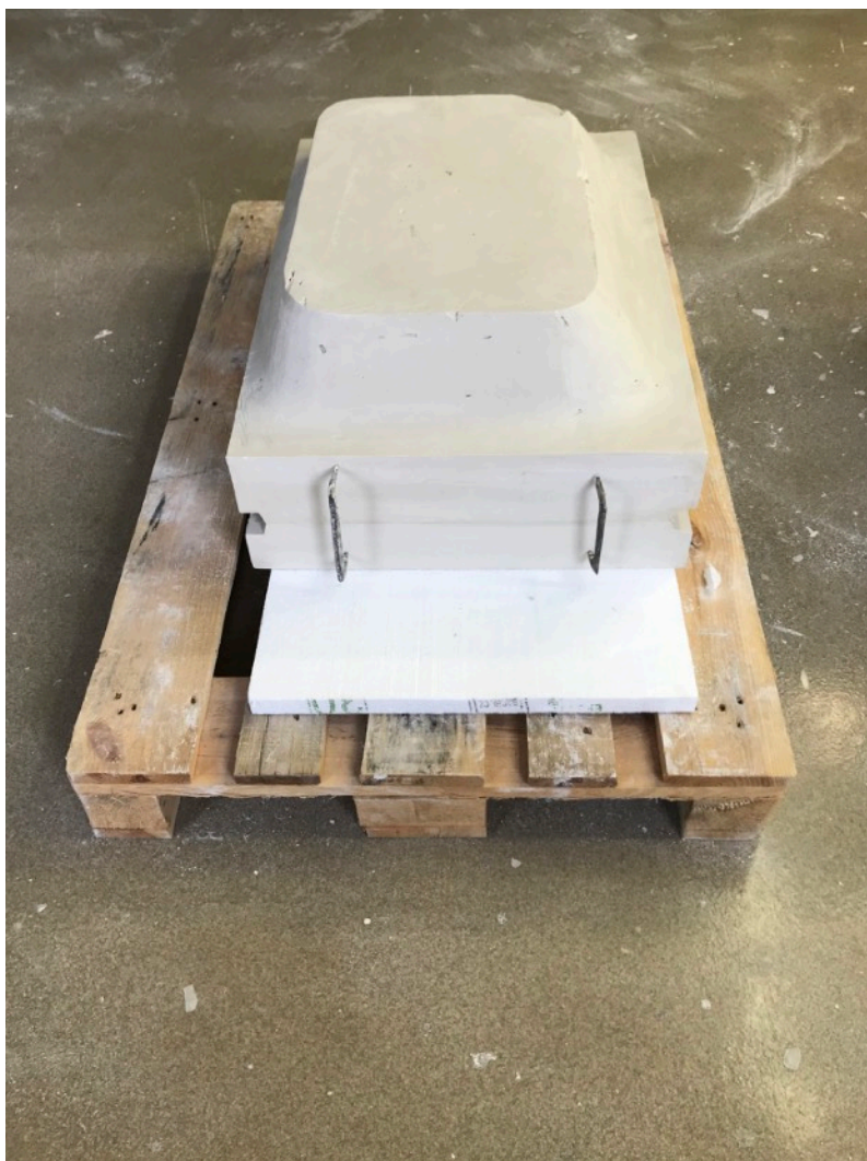
Kompletace formy a převoz na sušení
