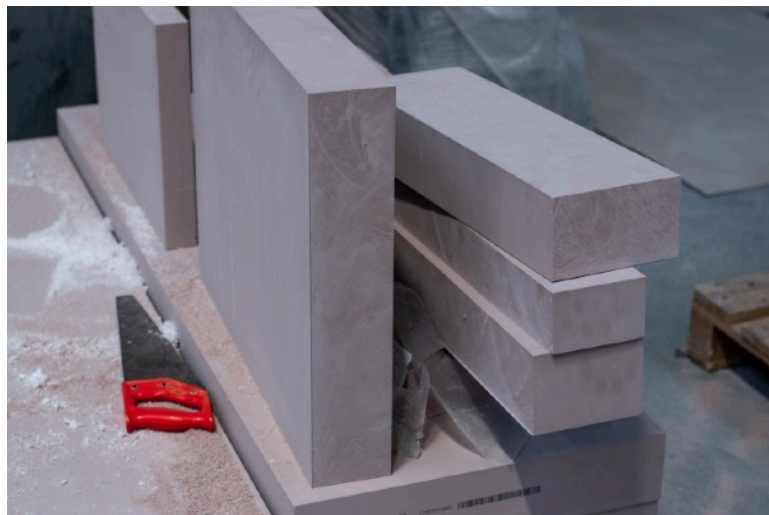
Rozřezané polyuretanové bloky
