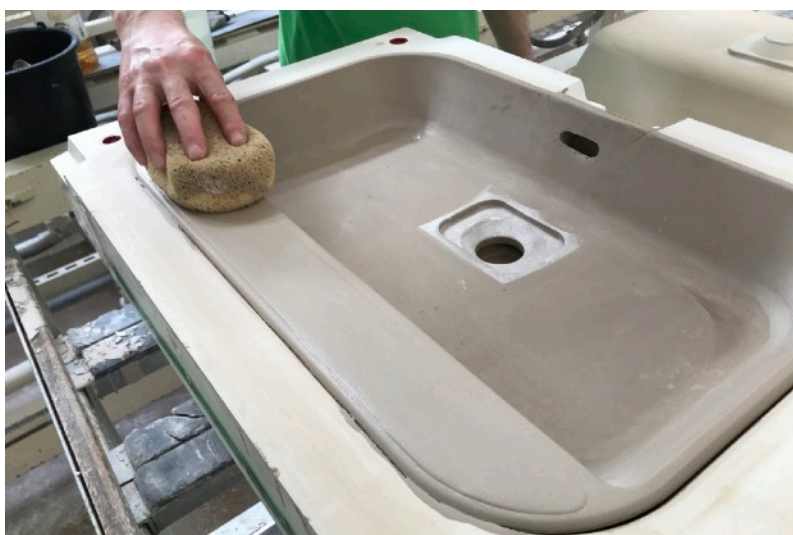
Začištění spoje vlhkou houbou
