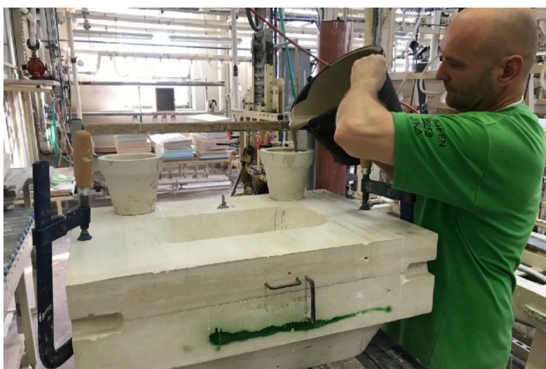
Zajištění formy svěrkami a kramlemi
