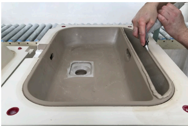
Nanášení sražené do spáry cirkulační komory
