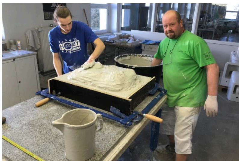
Ruční nanášení silné vrstvy sádry
