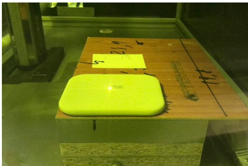
Zapékání firemního loga laserem do krytky odtoku
