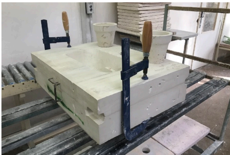
Zajištění formy svěrkami a kramlemi
