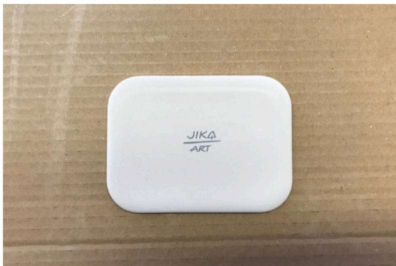
Zapékání firemního loga laserem do krytky odtoku
