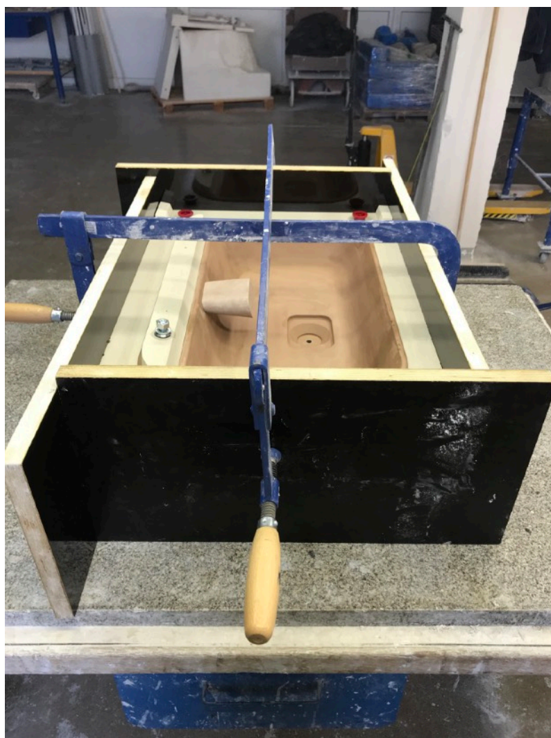
Nachystané bednění na vytvoření jádra formy
