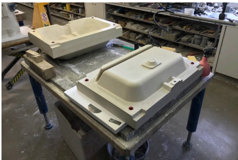
Vytvořené a začištěné jádro formy
