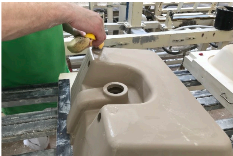
Odstranění přebytečné zárohliny škrabkou a následné začištění vlhkou houbou
