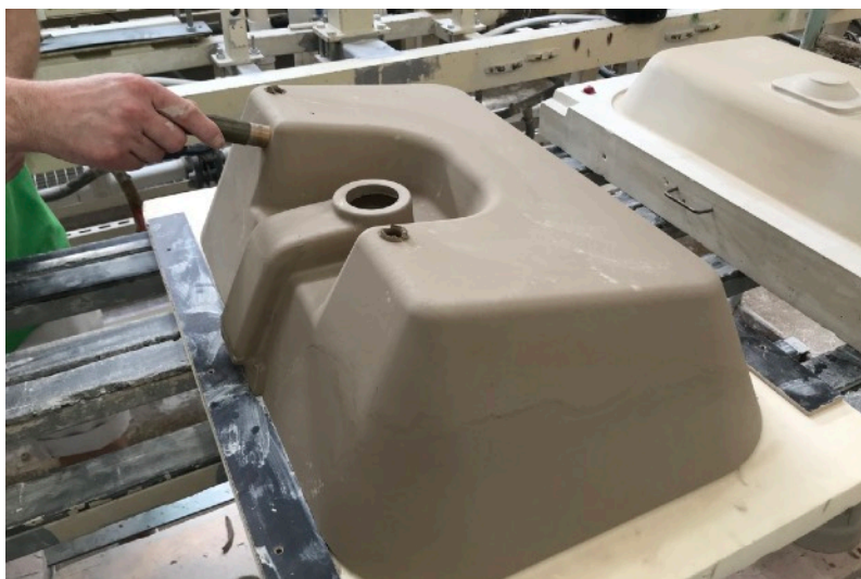
Vpichování otvoru do rezervoáru umyvadla
