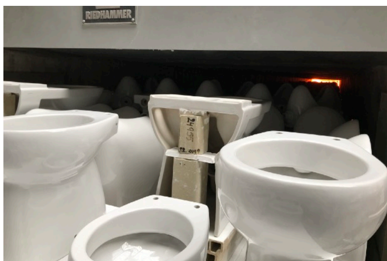
Pohled do pece s hotovými kusy vypálené keramiky
