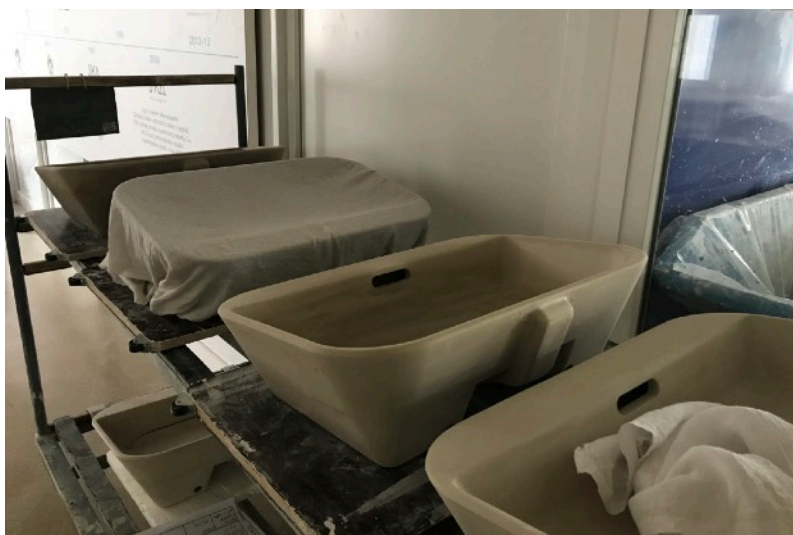
Převoz umyvadla na sušení, kde pozvolna schne přikryté vlhkou látkou
