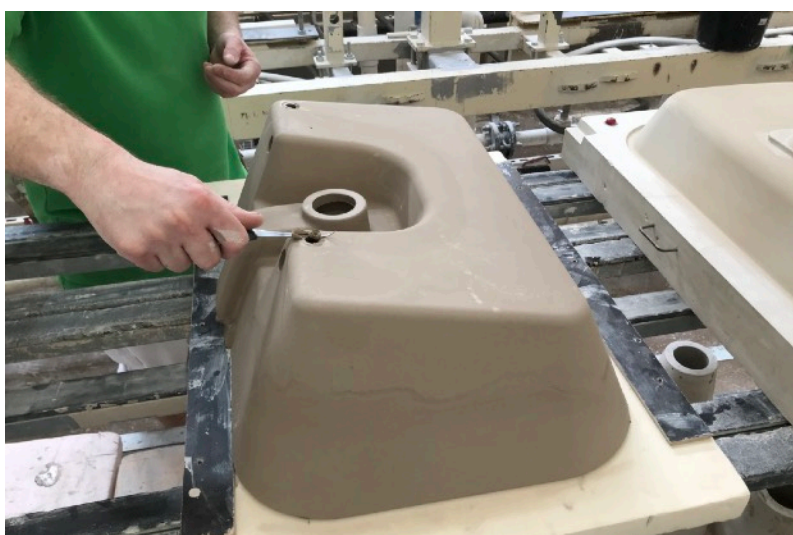
Začišťování otvorů vytvořených při spuštění
