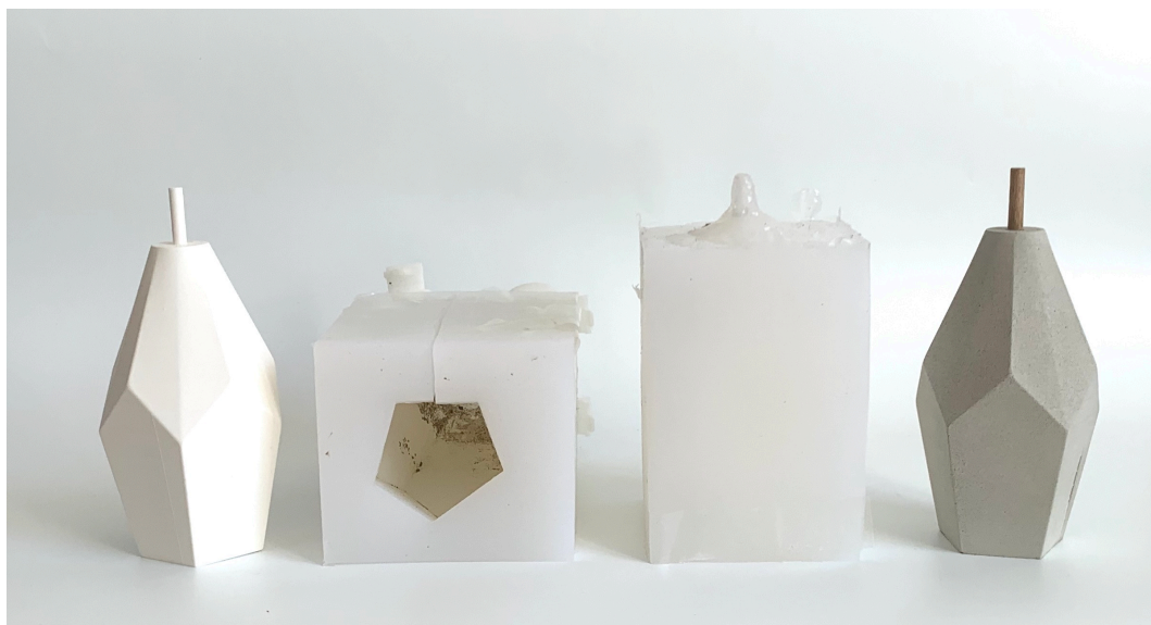
obr. 22 – proces výroby betonového odlitku
