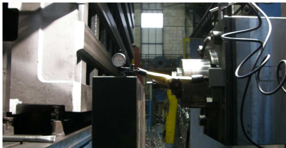
Obr. č. 38: Fotografie měření kolmosti v ose X
