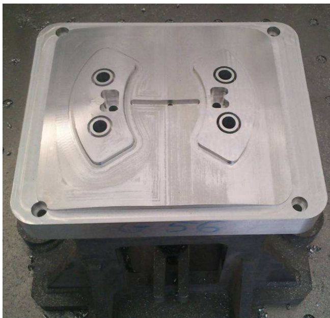
Obr. 5.6: Vyhazovací strana vstřikovací formy – frézování finálního tvaru
