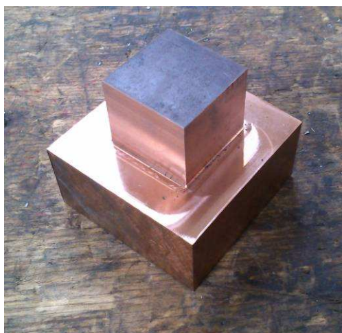
Obr. 4.24: Zhotovení upínací části elektrody
