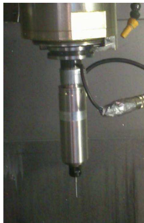
Obr. 4.20: Zrychlovací hlava upnutá ve vřeteni tříosé frézy [5]
