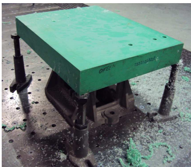
Obr. 4.2: Upnutí testovací desky na stole portálové frézky [5]
