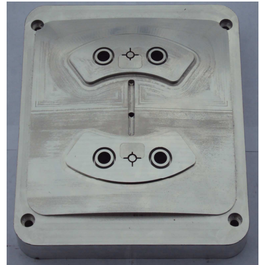
Obr. 5.8: Vyrobená vyhazovací strana vstřikovací formy
