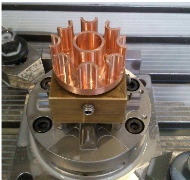
Obr. 4.26: Frézování elektrody č. 2 v přípravku [5]
