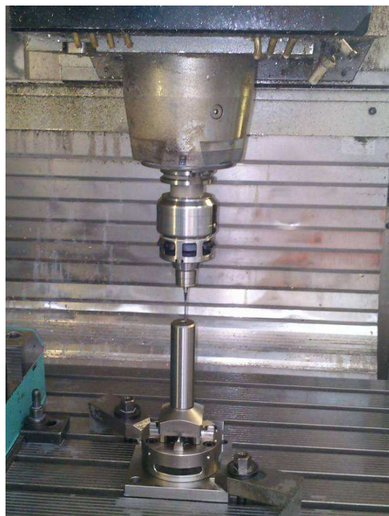
Obr. 4.25: Najetí nulového bodu přípravku s elektrodou [5]
