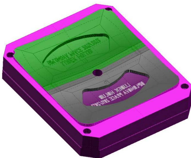
Obr. 5.9: CAD model pohledové strany vstřikovací formy
