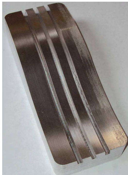
Obr. 4.16: Vyrobená hliníková vložka s torzními kanály
