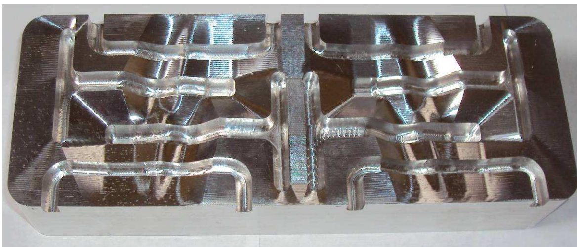
Obr. 4.29: Vyrobená hliníková vložka s vtokovými kanály
