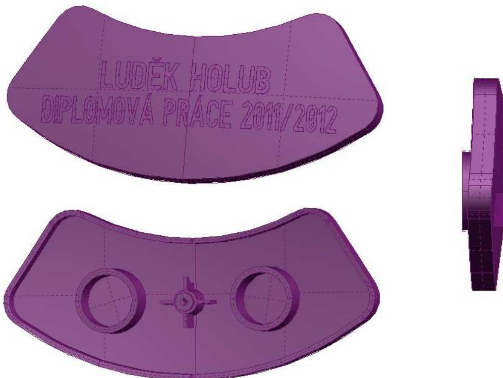
Obr. 5.1: Různé pohledy na CAD model požadovaného výlisku
