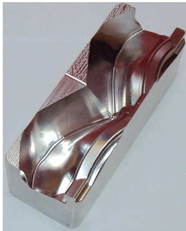
Obr. 4.31: Vyrobená hliníková vložka s tvarovou plochou
