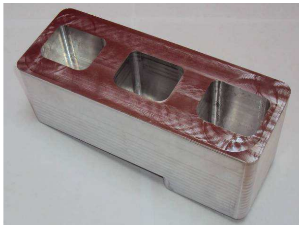
Obr. 4.14: Vyrobená hliníková vložka s různě hlubokými kapsami
