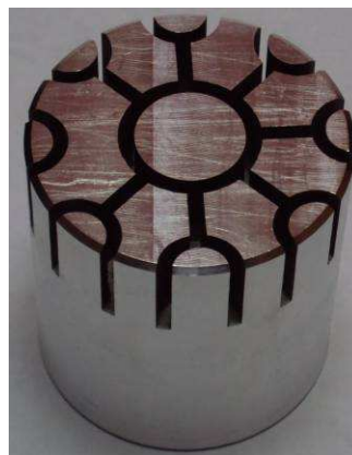
Obr. 4.22: Vyrobená hliníková vložka s tvarovými drážkami
