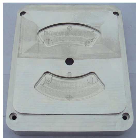
Obr. 5.10: Vyrobená pohledová strana vstřikovací formy
