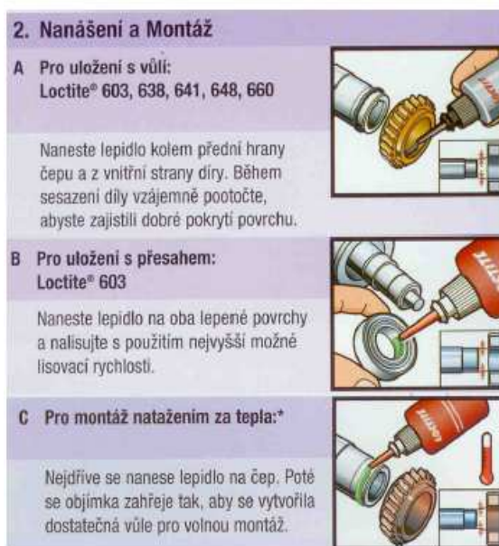
Obr.P5- 4 Nanášení a montáž
