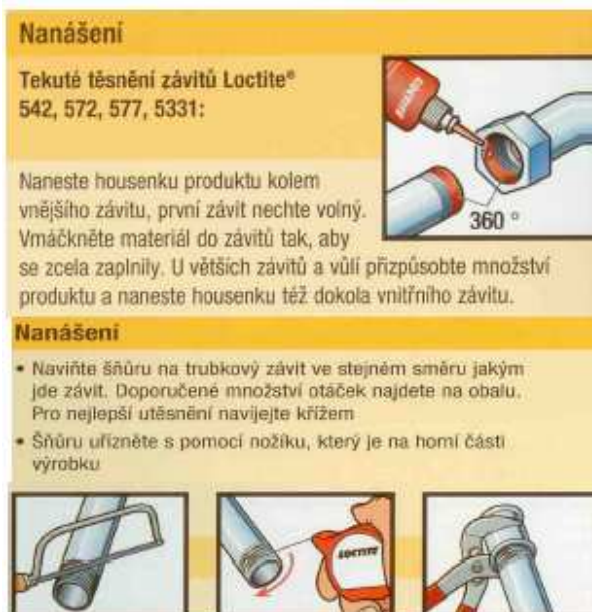
Obr.P5- 3 Nanášení produktu Loctite
