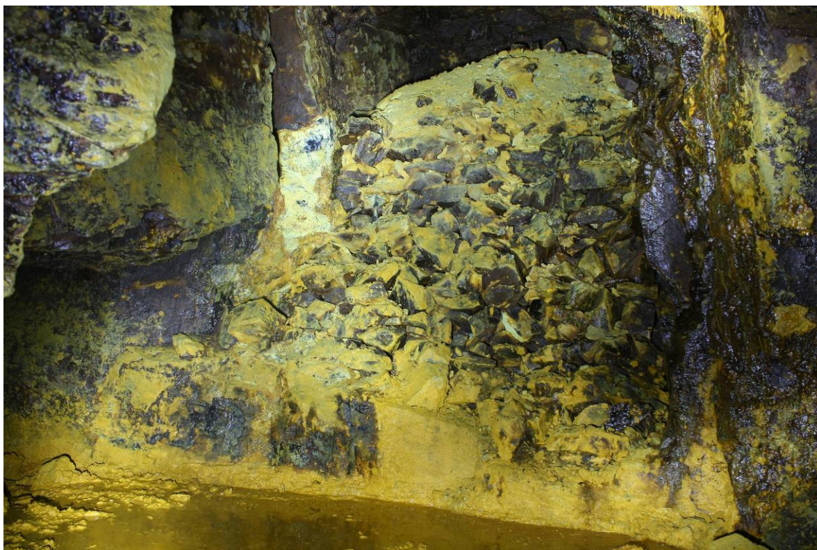
Obr. 26: Zakládka v podzemním systému
