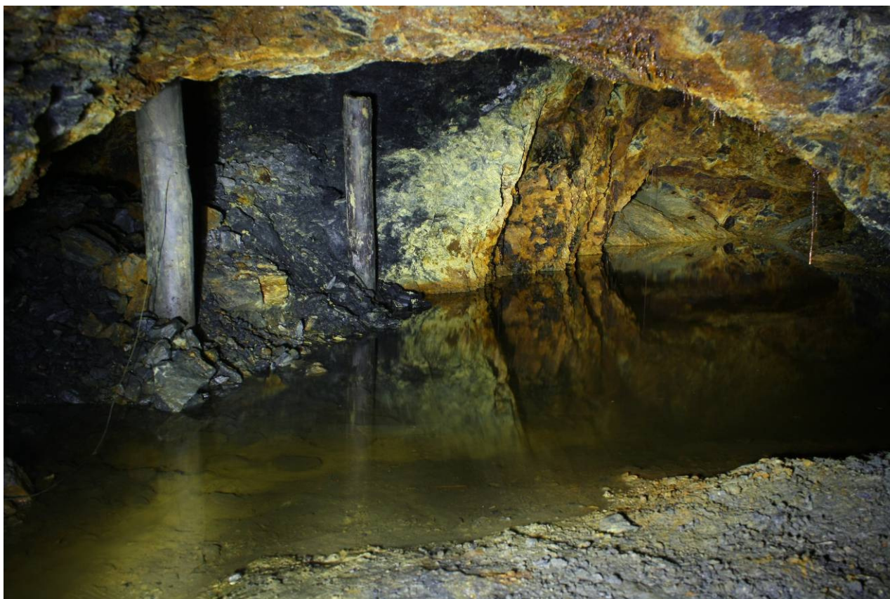
Obr. 34: Zatopená komora se zbytky výdřevy
