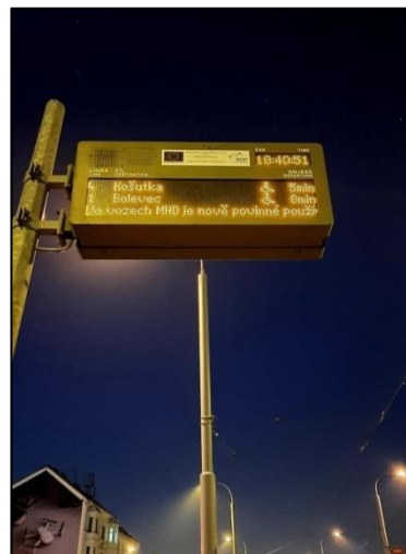
Obrázek 5 - LED panel zast. Pod Záhořskem
