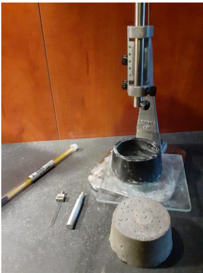
Obrázek 13 – Zkušební aparatura, Vicatův přístroj s nástavci (jehla, váleček), teploměrem a ztvrdlým zkušebním vzorkem
