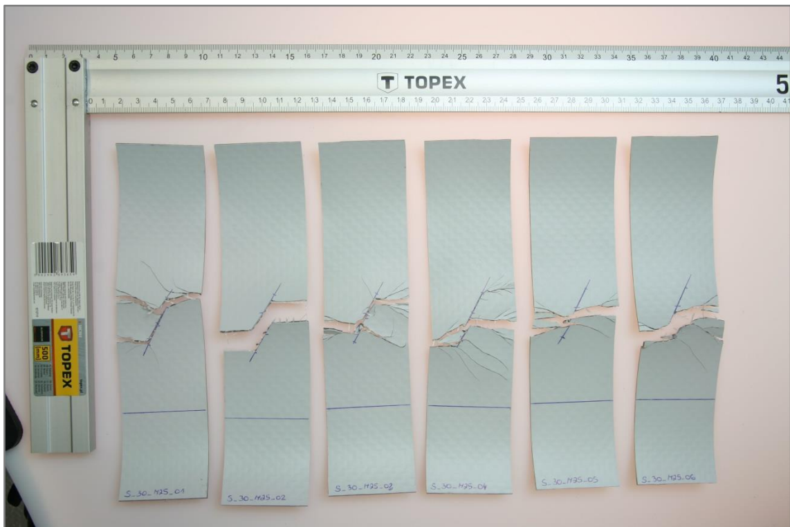
Obrázek 55: Vzorčky S_30_M25 po vykonání tahové zkoušky
