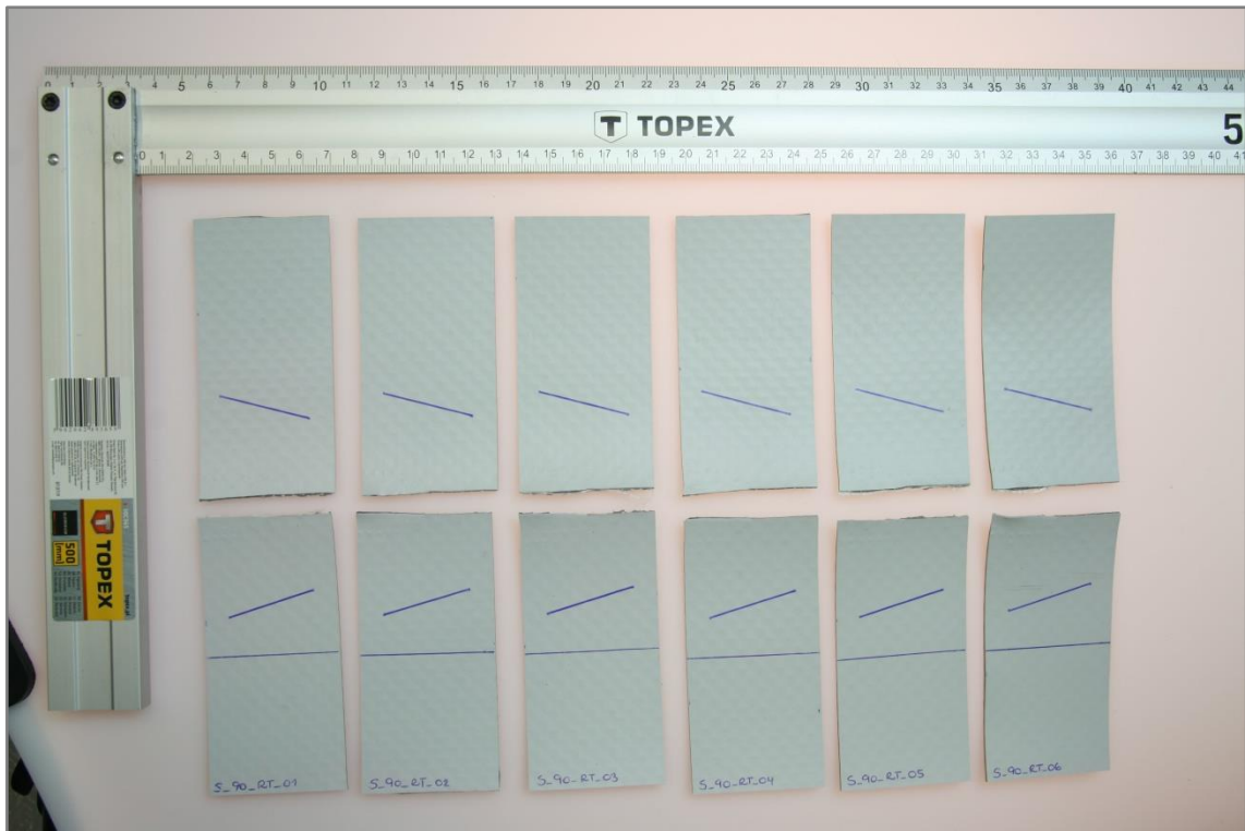
Obrázek 52: Vzorky S_90_RT po vykonání tahové zkoušky
