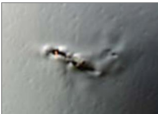
Obrázek 26: Poškození fólie v průběhu výroby [21]
