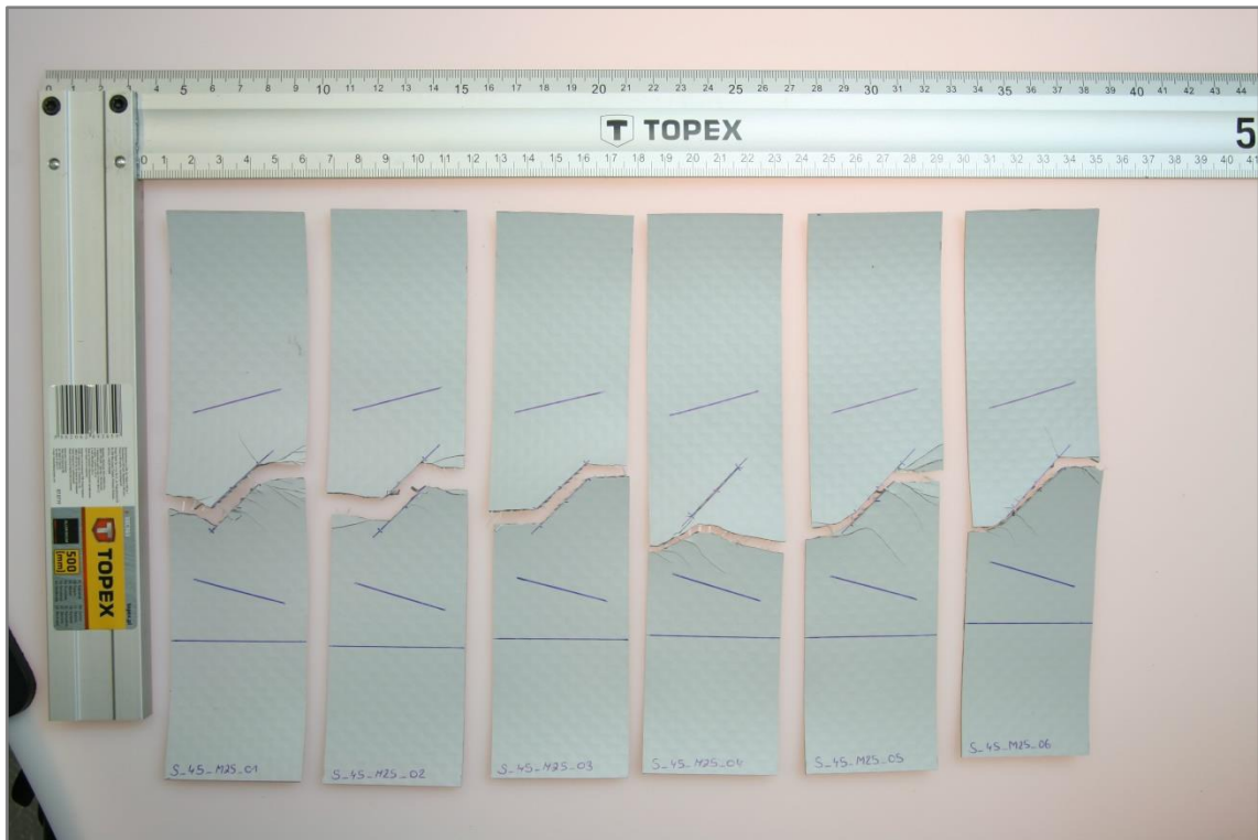
Obrázek 56: Vzorčky S_45_M25 po vykonání tahové zkoušky
