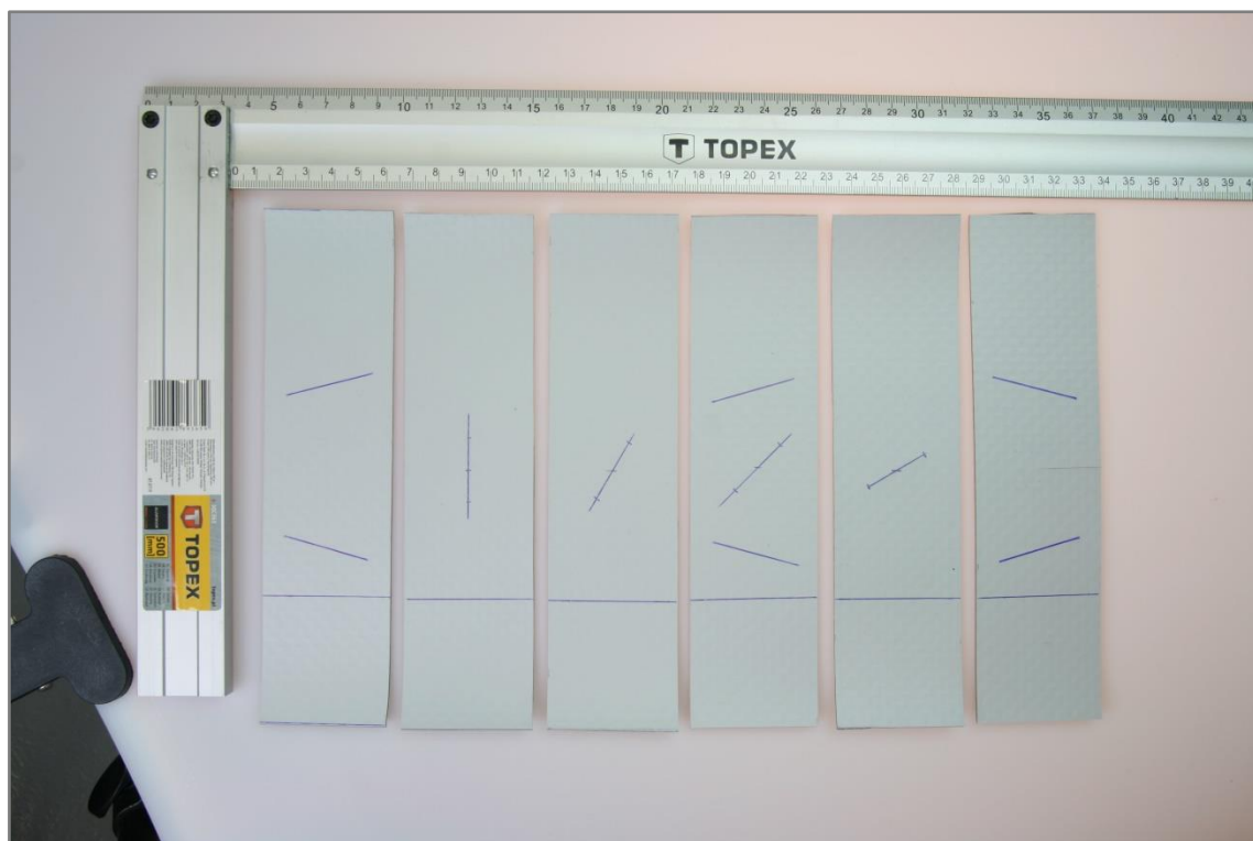
Obrázek 46: Vzorky před vykonáním tahové zkoušky
