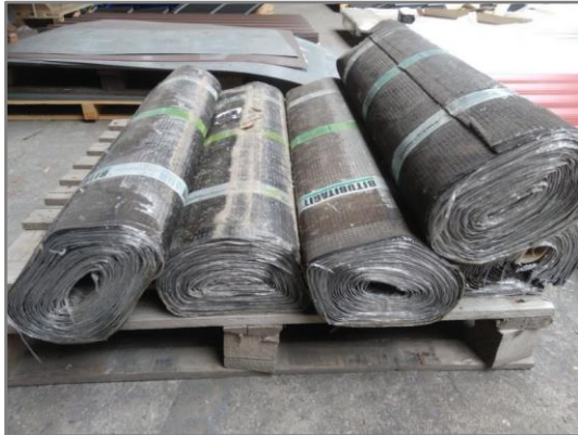
Obrázek 12: Nevhodné skladování asfaltových pásů naležato [22]
