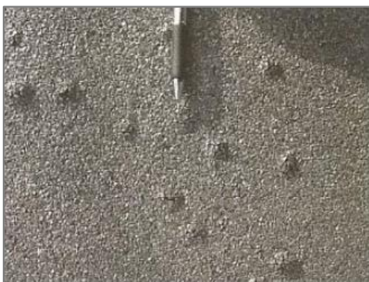
Obrázek 15: Puchýře na povrchu pásu [21]
