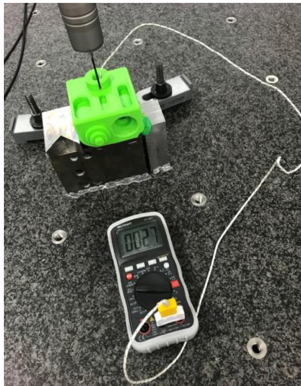
Obr. 2-7: Teplota dílu zjištěná externím teploměrem [vlastní]
