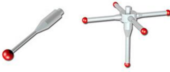
Obr. 1-3: Zakončení dotykového systému ve formě kuličky [3]
