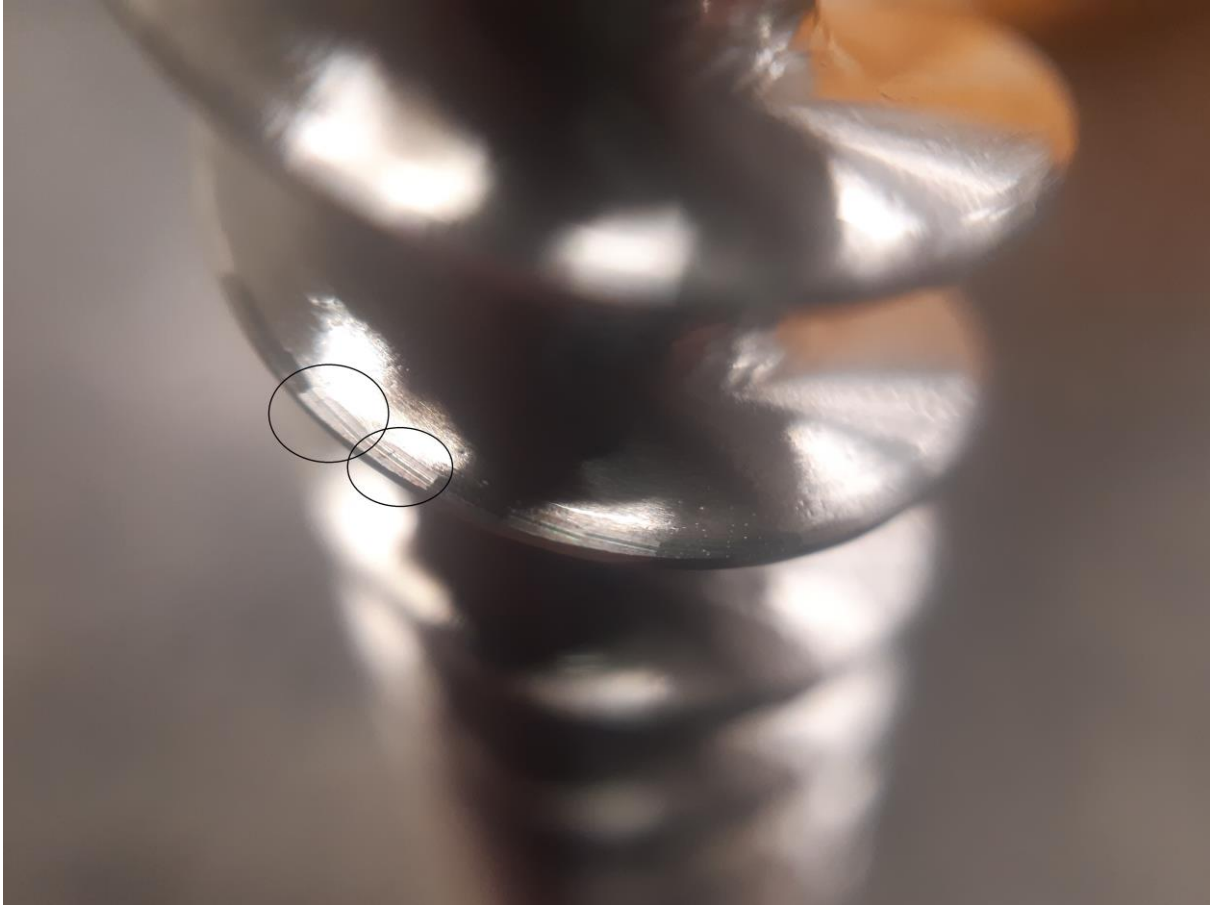
Obr. 4.4: Vzniklé plošky při jednorůchodovém broušení [4]
