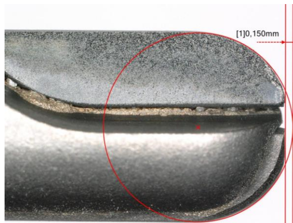
Obrázek 7.26 Opotřebení nástroje po 20 drahách na druhém z břitů
