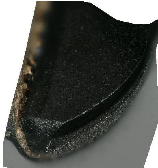
Obrázek 7.29 Stav druhého z břitů po 1. dráze
