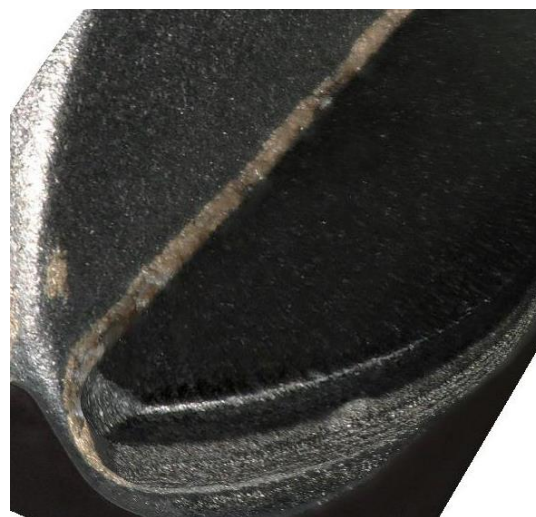
Obrázek 7.39 Stav druhého z břitů po 6. dráze
