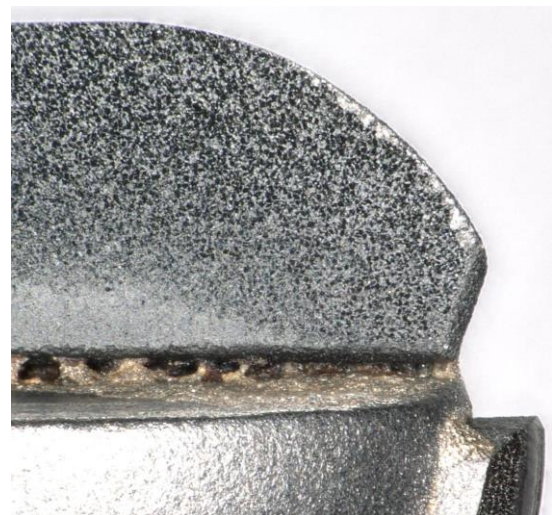
Obrázek 7.35 Pohled shora na druhý z břitů po 19. dráze
