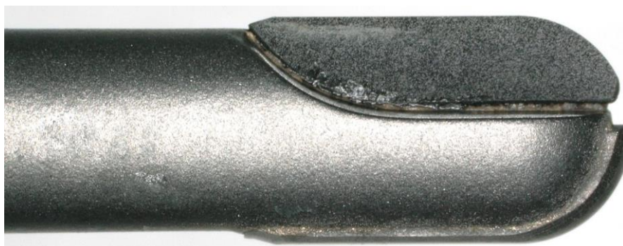
Obrázek 6.10 Snímek druhé břitové destičky nástroje s označením INDIABN04.06Z02R020
