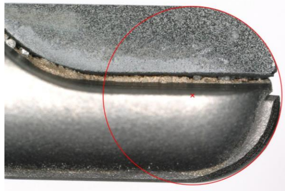
Obrázek 7.23 Opotřebení nástroje po 10 drahách na druhém z břitů
