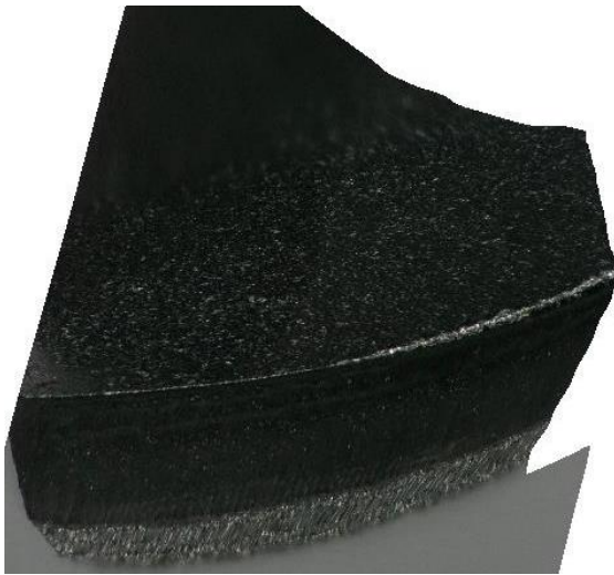
Obrázek 7.28 Stav jednoho z břitů po 1. dráze
