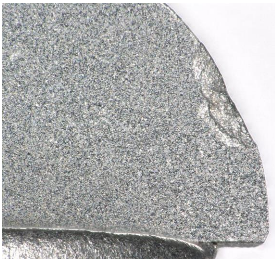
Obrázek 7.34 Pohled shora na jeden z břitů po 19. dráze
