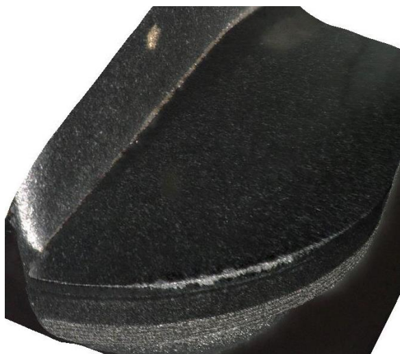
Obrázek 7.38 Stav jednoho z břitů po 6. dráze
