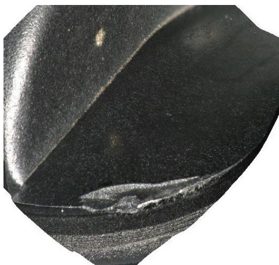
Obrázek 7.40 Stav jednoho z břitů po 14. dráze
