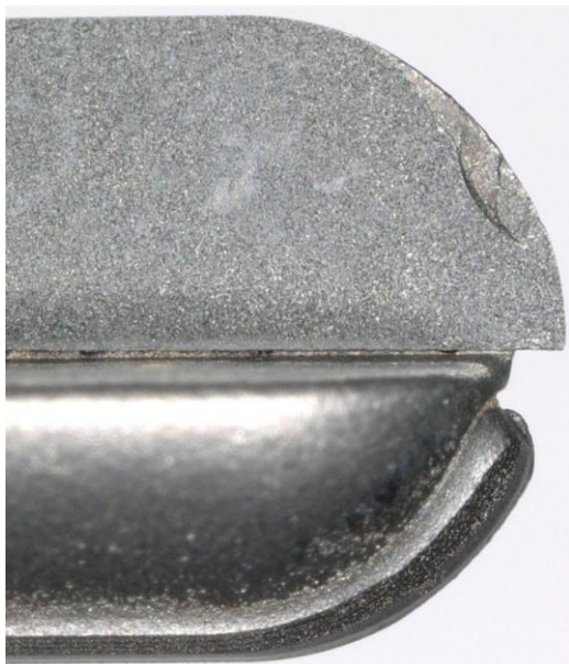
Obrázek 7.42 Pohled shora na jeden z břitů po 14. dráze
