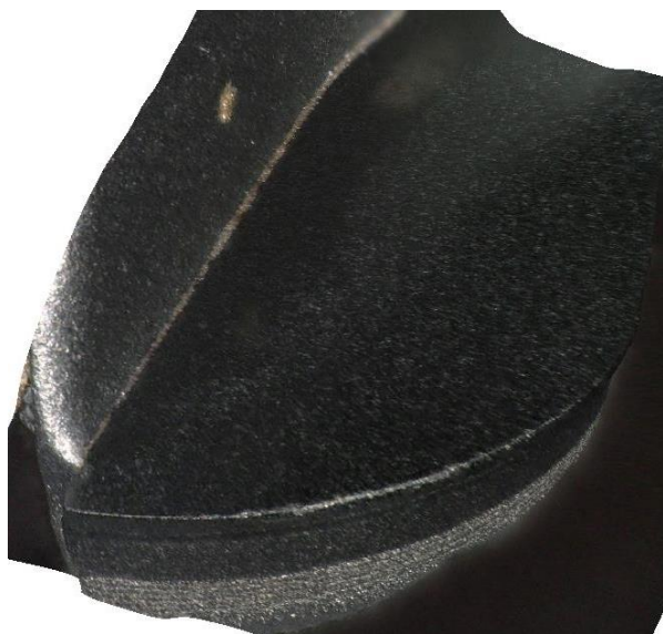
Obrázek 7.36 Stav jednoho z břitů po 3. dráze
