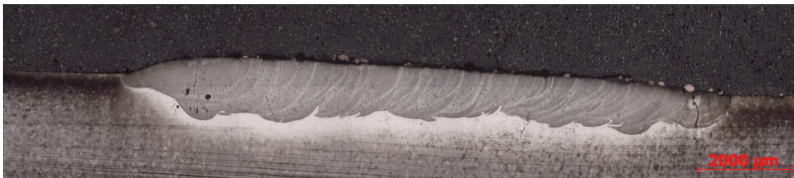
Obr. 21: Vzorek CE5_02; makrosnímek laserového návaru; leptáno; zvětšeno 25x
