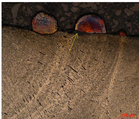
Obr. 27: Vzorek CE5_02; čedič na povrchu laserového návaru (viz. žlutá šipka); leptáno, zvětšeno 200x
