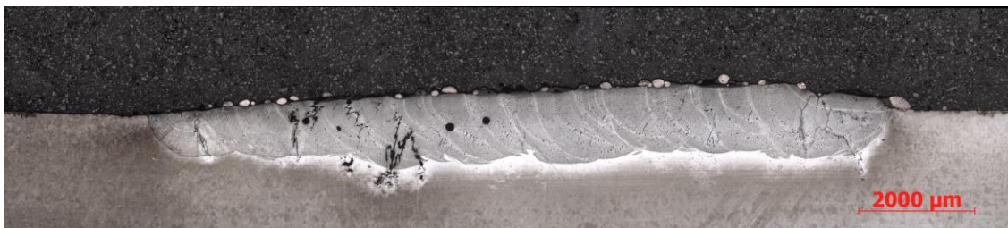
Obr. 20: Vzorek CE5_01; makrosnímek laserového návaru; leptáno; zvětšeno 25x
