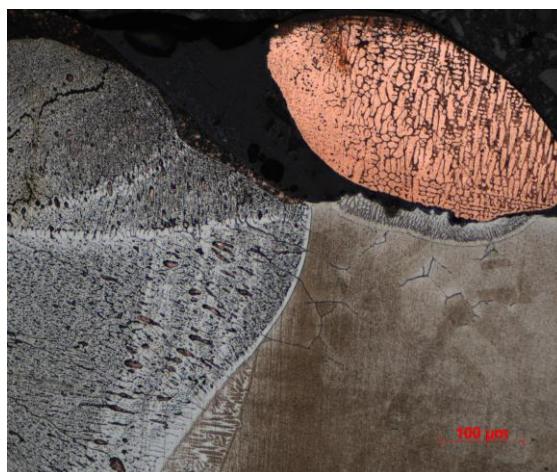
Obr. 24: Vzorek CE5_01; interkrystalické trhliny orientované kolmo na hranici ztavení laserového návaru a substrátu; leptáno; zvětšeno 200x
