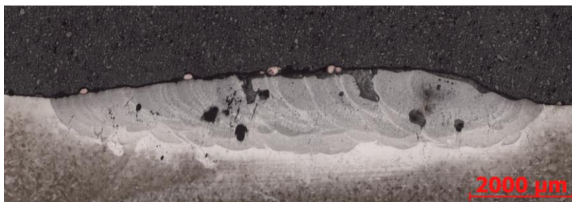
Obr. 22: Vzorek CE5_03; makrosnímek laserového návaru; leptáno; zvětšeno 25x
