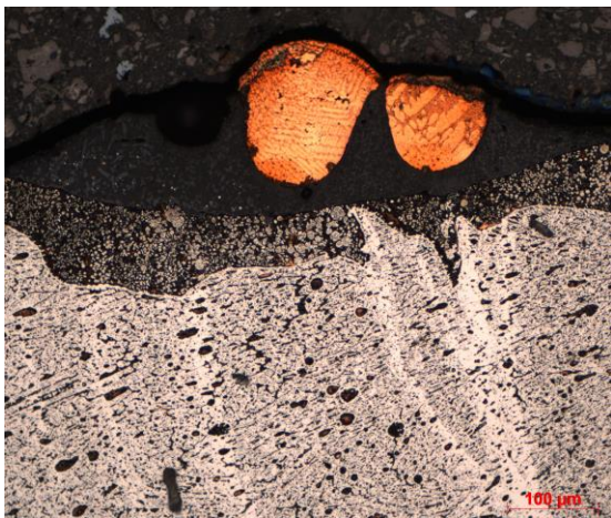
Obr. 28: Vzorek CE5_03; heterogenita laserového návaru; čedič na povrchu laserového návaru; natavené částice přidavného měděného prášku na povrchu návaru; leptáno; zvětšeno 200x
