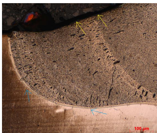
Obr. 26: Vzorek CE5_02; první laserem navařená housenka; žluté šipky ukazují na přítomnost oxidu (čediče); modré šipky poukazují na trhliny na hranici ztavení; leptáno; zvětšeno 200x
