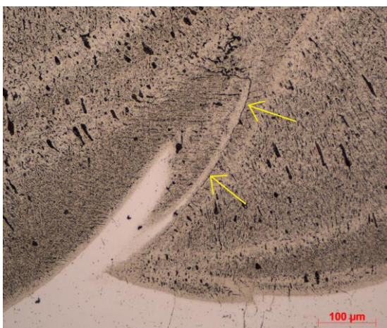
Obr. 25: Vzorek CE5_02; hranice ztavení; iniciační oblast trhliny (žluté šipky); leptáno; zvětšeno 200x
