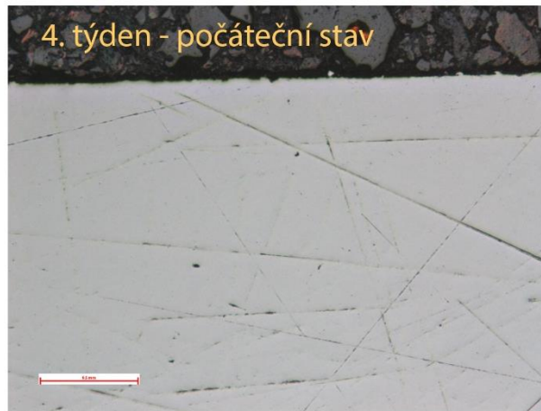
Obrázek 21 - Vzorek E – titan, 4. týden v korozní komoře, počáteční stav
