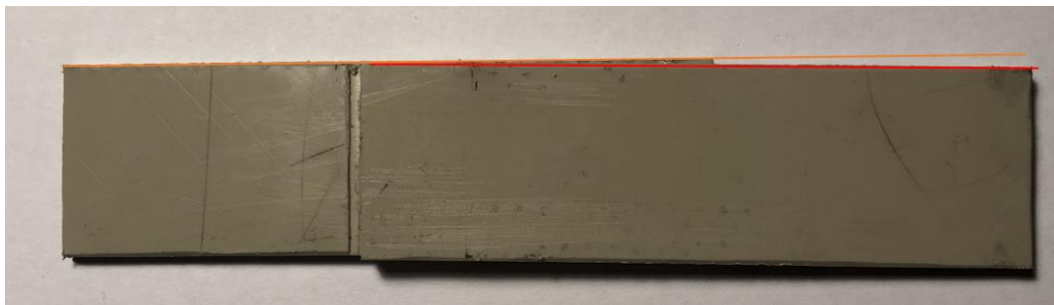
Obrázek 50: Test aretačního č. 2 – před úpravou; výsledkem je nerovnoběžně svařený vzorek [17]
