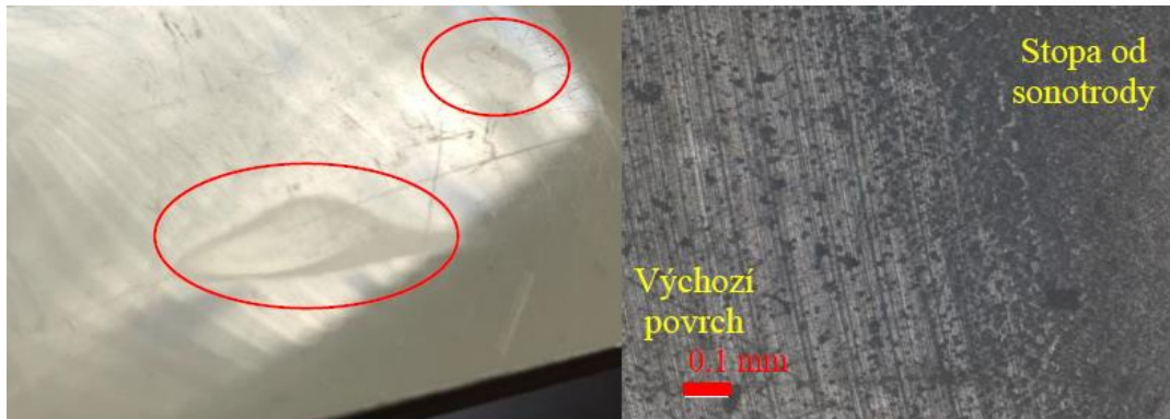
Obrázek 63: Stopy od sonotrody na horním díle vzorku; vlevo fotka dílu; vpravo snímek ze světelného mikroskopu (zvětšeno 25x) [17]
