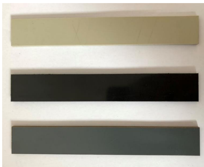
Obrázek 41: Nařezané polotovary o rozměru 200x30x4 mm, dole PVC, uprostřed PE-HD, nahoře PP [17]
