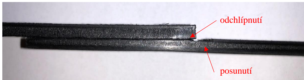
Obrázek 48: Test aretačního přípravku č. 1; výsledkem je odchlípnutí a posunutí spodního dílu vzorku [17]
