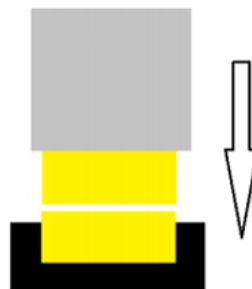
Obrázek 29: Kontakt sonotrody se svařovaným dílem [11]
