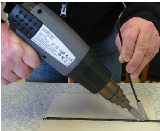
Obrázek 13: Svařování horkým plynem s rychlotryskou [28]
