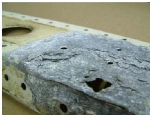
Obr. 2.5. – Koroze duralu po vrstvách [12]
