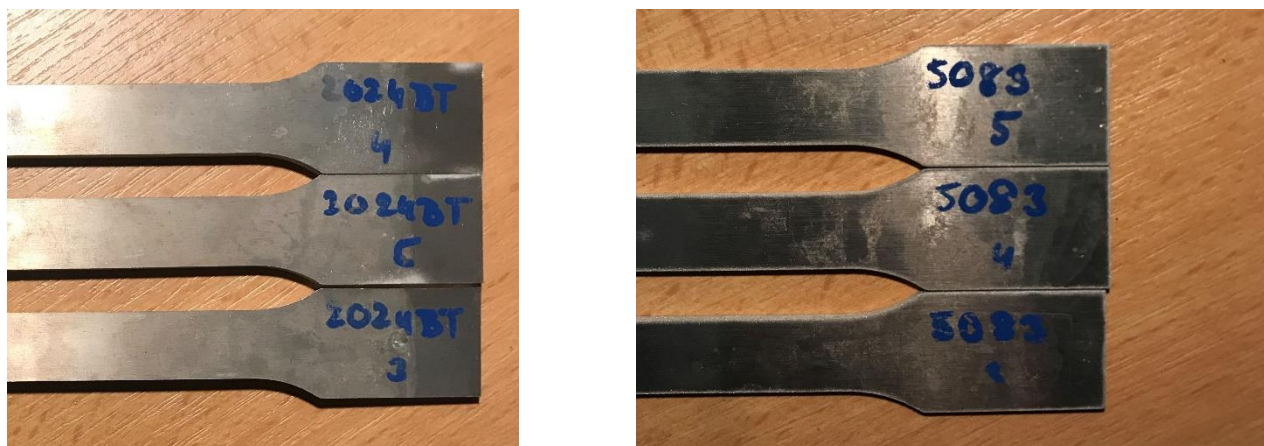
Obr. 6.1. a 6.2.– Slitiny EN AW-2024BT a EN AW-5083 po korozi
