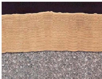
Obr. 4: Multivrstevný systém TiN/TiCN (vlevo), šíření trhliny multivrstevným systémem (vpravo) [10]
