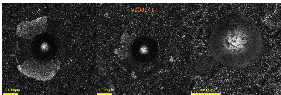
Obr. 22: Mercedes test – detaily vtisků u vzorku E
