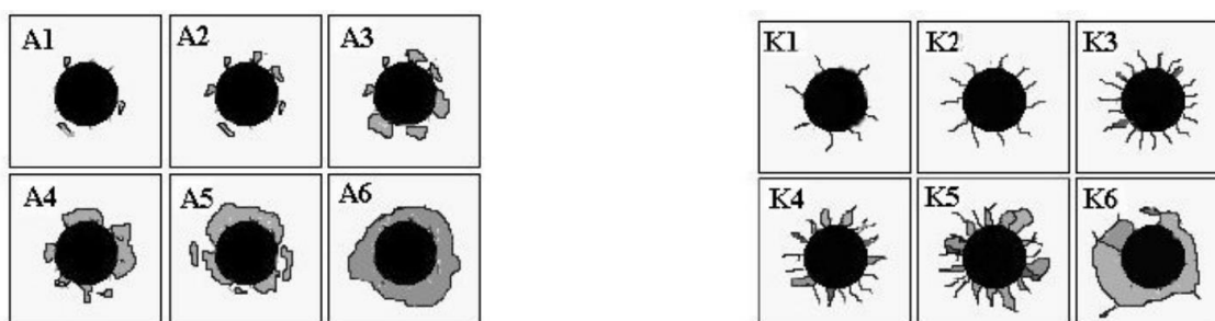
Obr. 20: Hodnocení porušení okolí vtisku při zatížení 1500 N [35]
