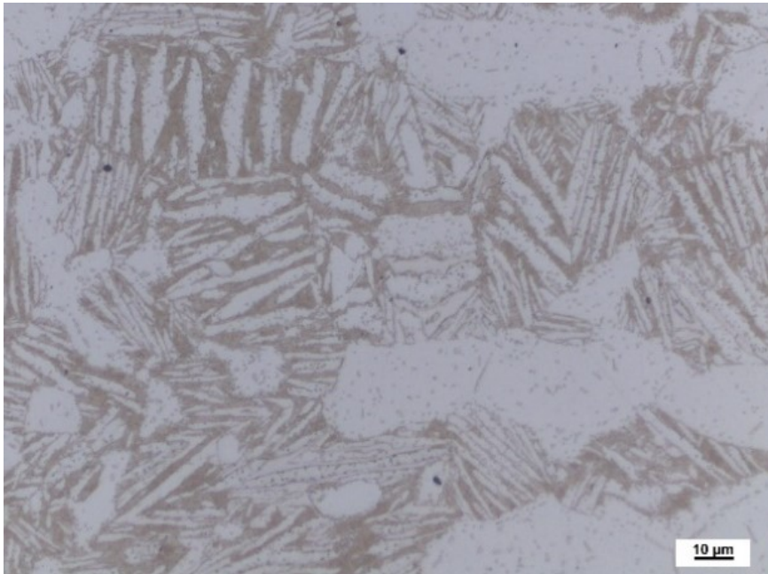
Obrázek 55: Mikrostruktura kaleného materiálu z 1100 °C, popuštěného na 900 °C, T20/038A, zvětšení 500x
