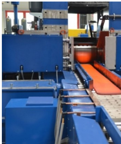
Obrázek 13: Válcovací duo stolice
