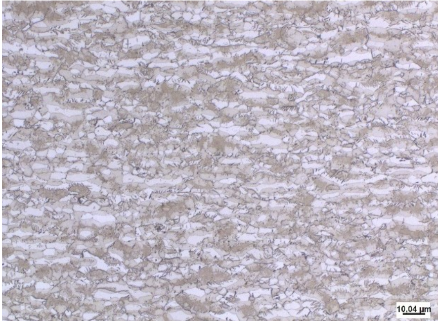
Obrázek 22: Mikrostruktura po homogenizačním žíhání materiálu T20/038A, zvětšení 50x
