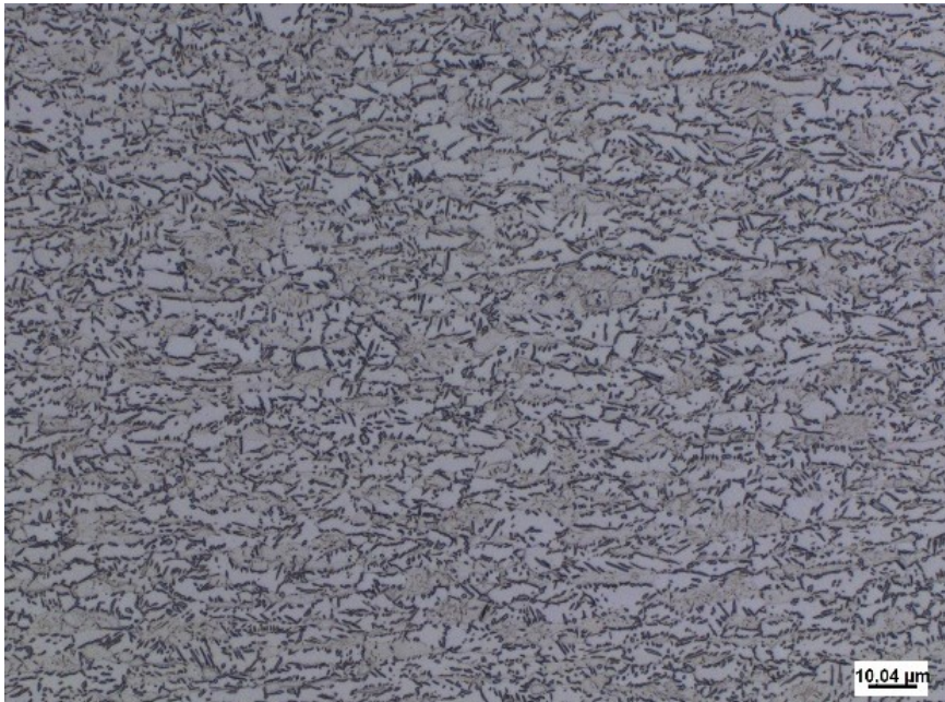
Obrázek 28: Mikrostruktura po normalizačním žihání materiálu T20/038C, zvětšení 50x
