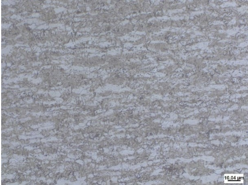
Obrázek 26: Mikrostruktura po normalizačním žhání materiálu T20/038A, zvětšení 50x
