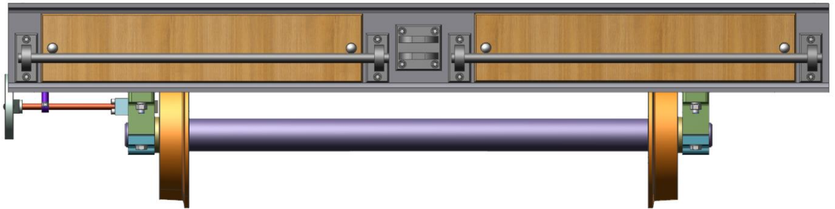
Obrázek 46-Definitivní stavební struktura-Kolejový vozík-Čelní pohled
