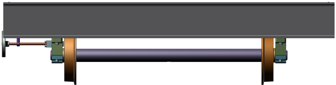
Obrázek 25-Hrubá stavební struktura-Kolejový vozík-Čelní pohled
