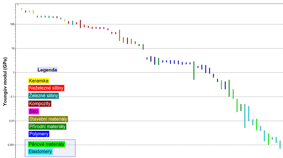
Obr. 7: Ukázka nízkých hodnot modulu pružnosti elastomerů a pěnových materiálů
