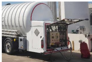
Obr. 3 Strojní zařízení- čerpadlový systém [14]
