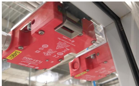
Obr. 21 Elektromechanické blokovací zařízení se zádržnou silou
