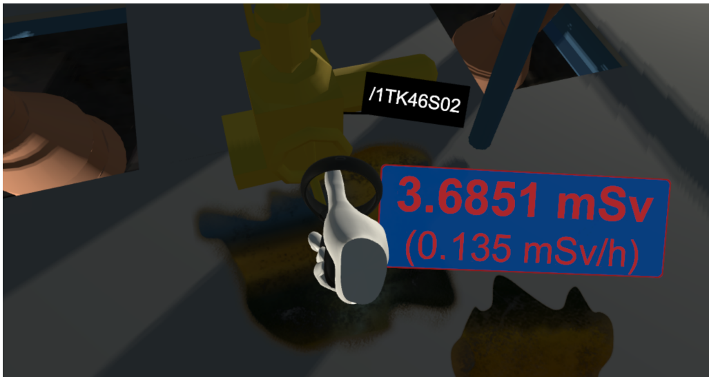
Obrázek 7.3: Osobní dozimetr při překročení nastaveného limitu ekvivalentní dávky uživatele v blízkosti zdroje vysokých dávek radiace
