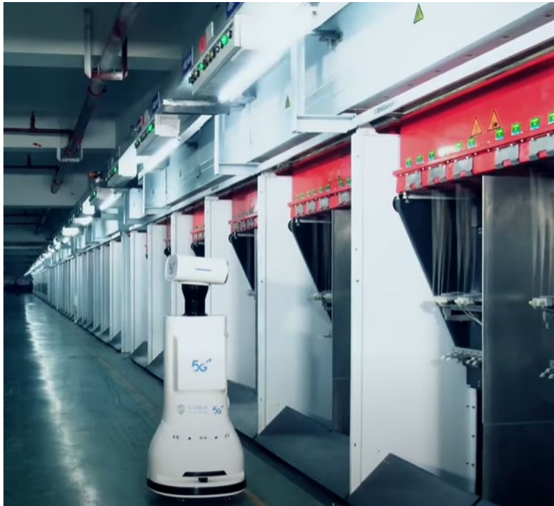
Obrázek 5: Inspekční robot při kontrole vláken [44.]
