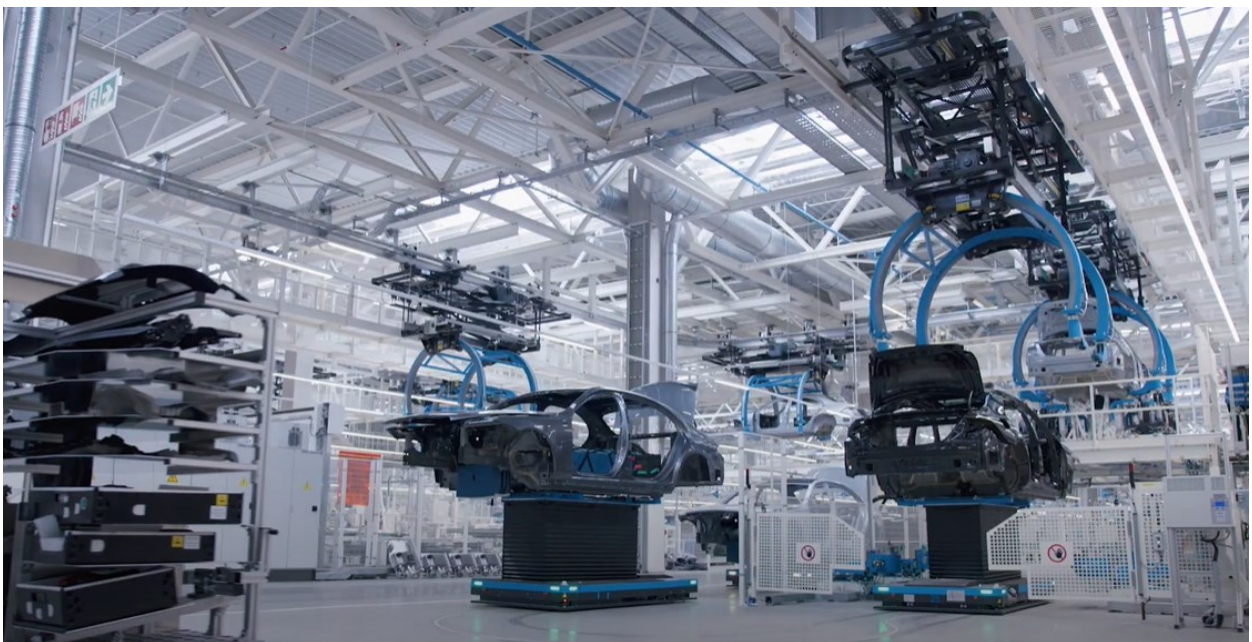
Obrázek 6: AGV přepravující karosérii vozu [43.]
