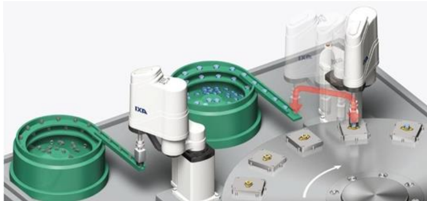
Obr. 7 Aplikace robota SCARA – vysokorychlostní pick and place úloha [29]
