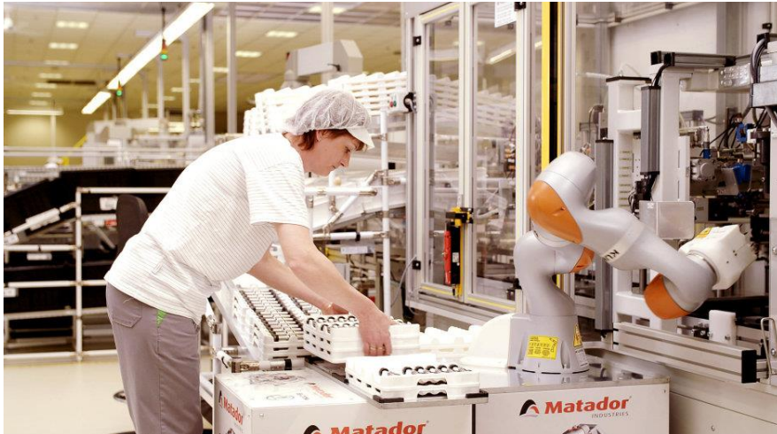
Obr. 13 Pracoviště s kolaborativním robotem [34]
