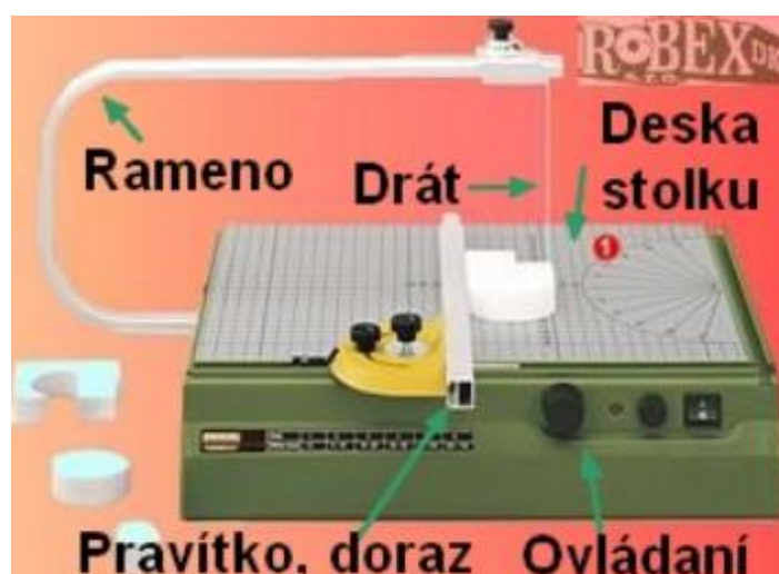
Obrázek 16: Stolní řezačka s odporovým drátem [30]
