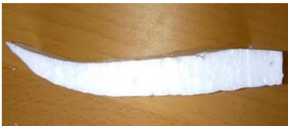
Obrázek 43: Řez EPS polystyrenu drátem kanthal
