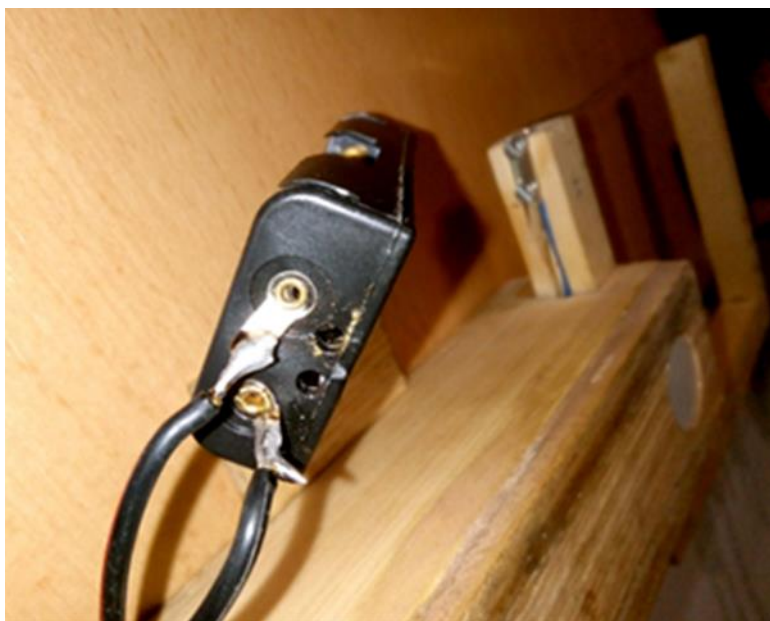
Obrázek 25: Propálené kontakty v boxu baterie
