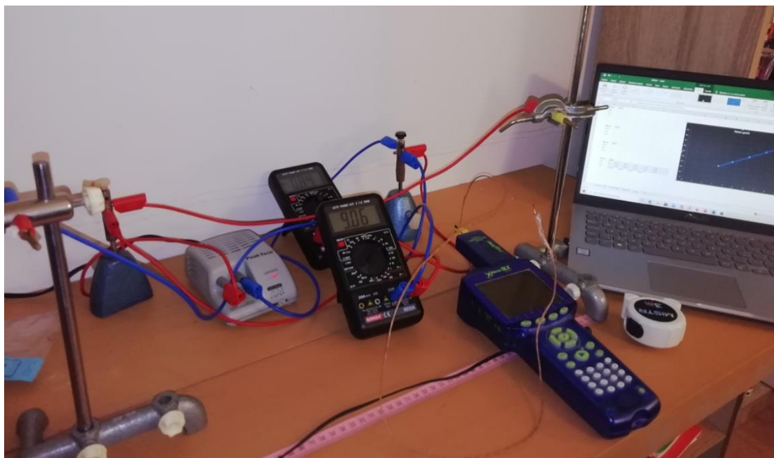
Obrázek 42: Měřicí pracoviště – měření odporových drátů
