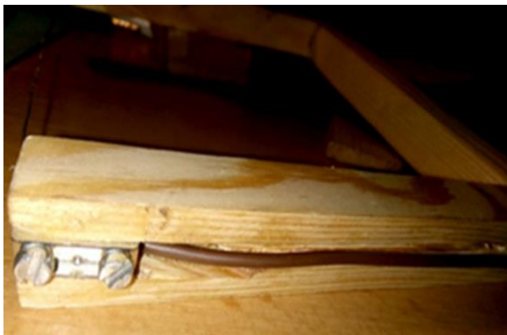
Obrázek 24: Umístění svorkovnice s vodičem v drážce
