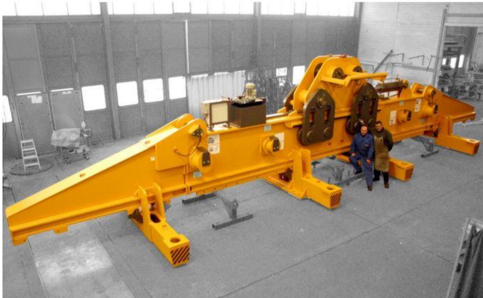
Obrázek č. 26 Vyvažovací rádiově ovládaná traverza s nosností 380 tun [6].
