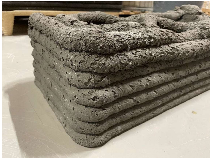
Obrázek 32 Boční detail vytisknutého objektu s pohledem na texturu
