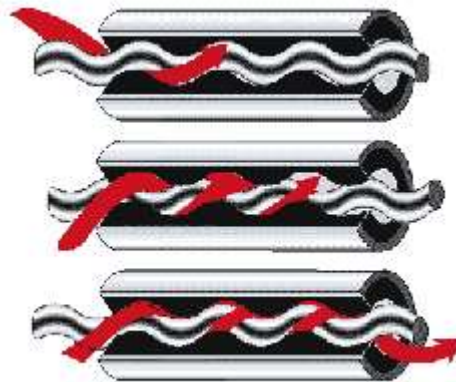
Obrázek 2 Schéma funkce vřetenového čerpadla [4]
