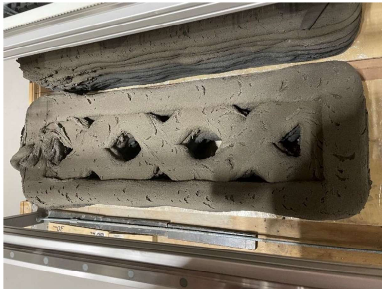
Obrázek 38 Vreční detail vytištěného objektu
