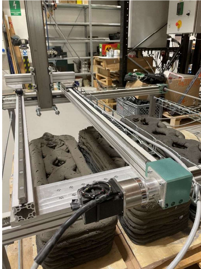
Obrázek 28 Detail rámu s pohledem na osu X, Y a Z
