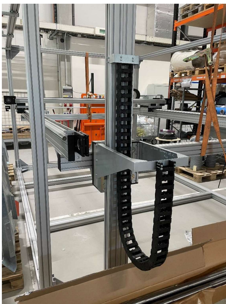
Obrázek 42 Pohled na osu Z s energořetězem na rozpracovaném rámu
