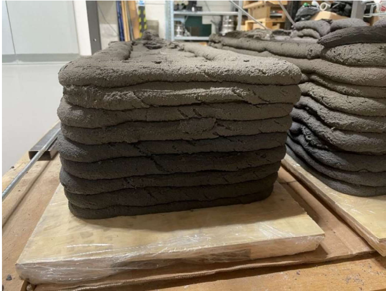
Obrázek 37 Boční detail vytištěného objektu
