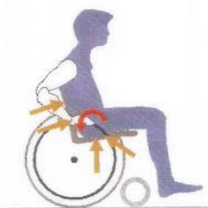
Obrázek 28 Nesprávné nastavení úhlu opěrky [37]
