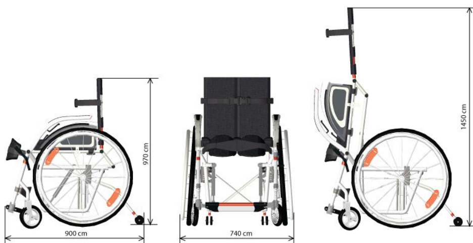
Obrázek 58 Základní rozměry vozíku
