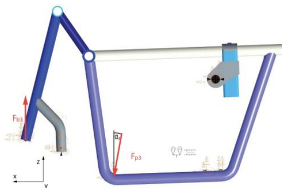
Obrázek 75 3. Zátěžný stav – uživatel stojí
