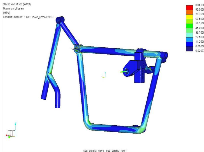
Obrázek 77 Pohled 2 - Zobrazení výsledků redukovaného napětí dle hypotézy von Mises v MPa pro první zatěžující stav rámu
