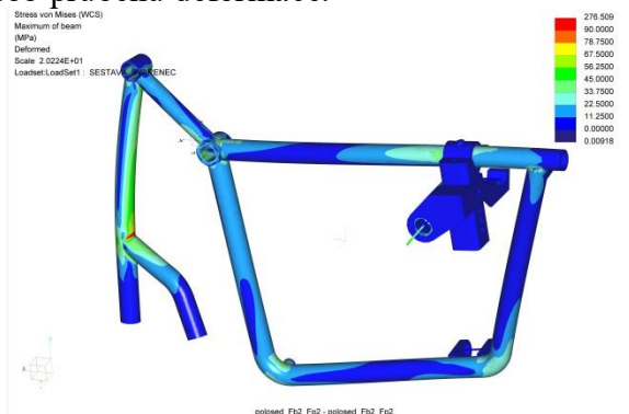
Obrázek 94 Deformovaný rám – zatížení člověkem v polosedící poloze
