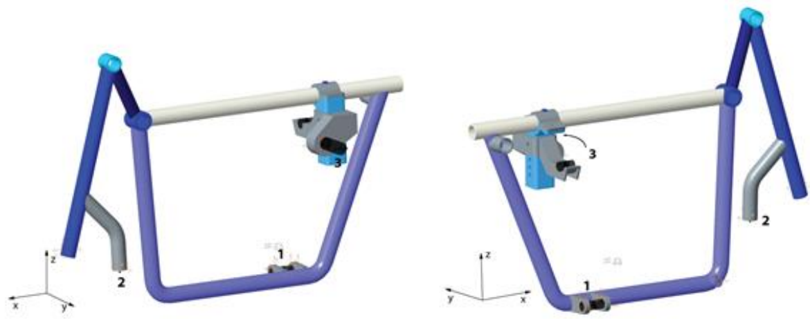
Obrázek 72 Pohledy na rám s definovanými okrajovými podmínkami
