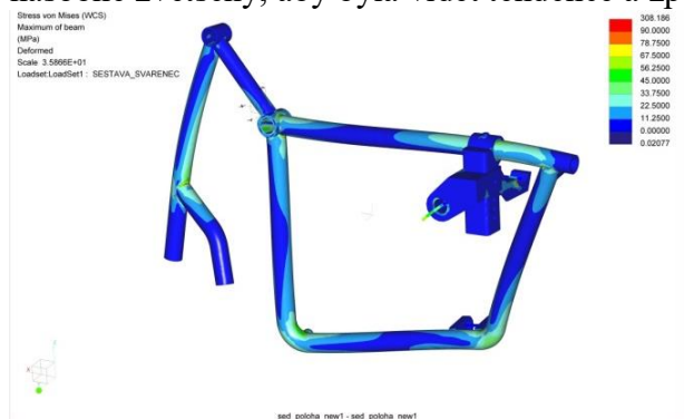
Obrázek 93 Deformovaný rám – zatížení člověkem v sedící poloze
