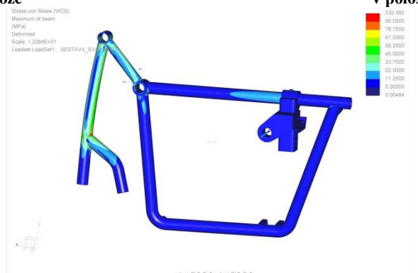
Obrázek 95 Deformovaný rám – zatížení člověkem stojícím
