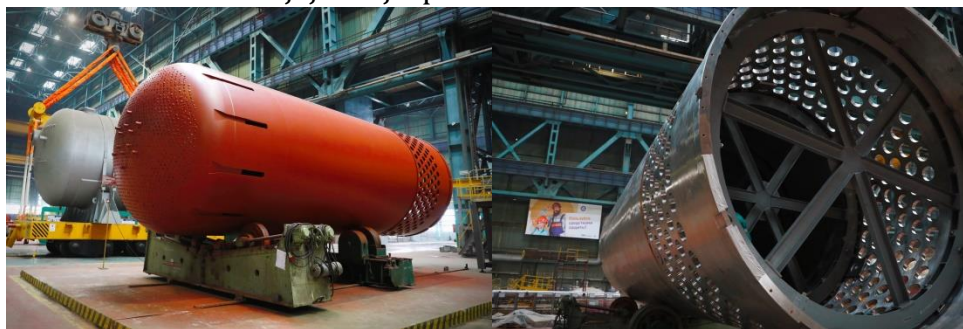
Obr. 82 – vnitřní reaktorové šachty vyrobené ruskou společností Rosatom pro JE Rooppur v Bangladéši v roce 2020 [19]
