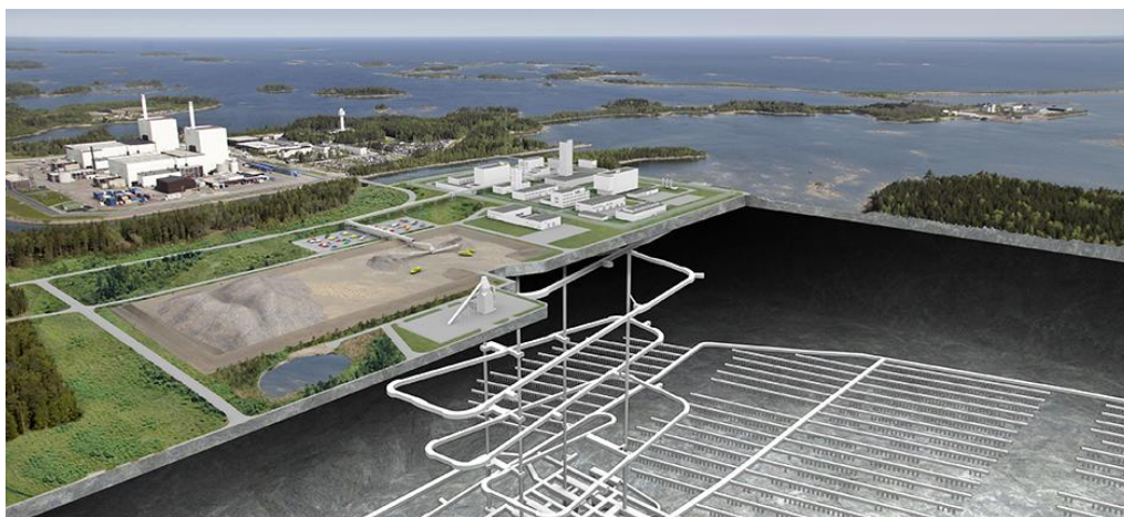
Obr. 74 – Schéma podmořského úložiště Forsmark ve Švédsku [12]
