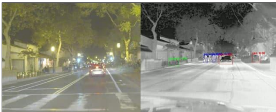
Obr. 14: Porovnání nočního obrazu z RGB (vlevo) a NIR kamery (vpravo) [26]
