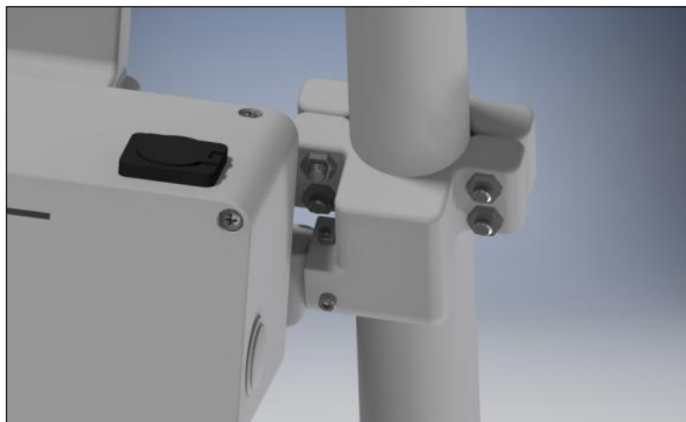
Obr. 48: Detail svěrného spoje s nastavením sklonu šrouby
