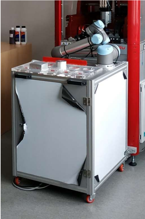
obrázek 2-12 kobot stojící na mobilní jednotce
