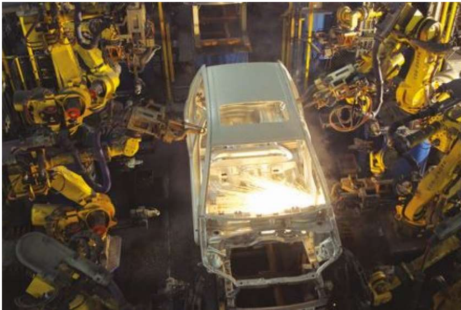
obrázek 1-1 Svařovací roboti v automobilovém průmyslu [3]
