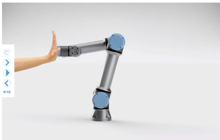
obrázek 5-1 kolize robota s lidskou rukou
