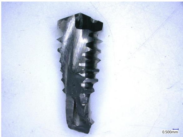
Obr. 29 Fotka zlomené závitorezné frézy
