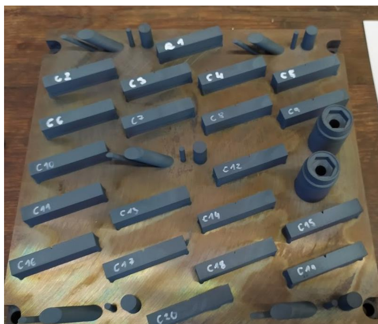
Obr. 29 Platforma III. tisk - po vyžihání a před oddělením vzorků od základní desky
