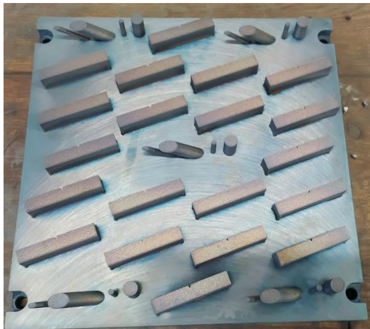
Obr. 28 Platforma II. tisk - po vyjmutí ze žíhací pece
