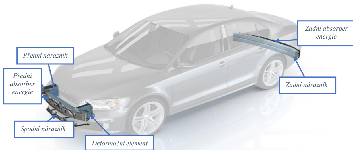
Obr. 4.2 - Nárazníky Shape Corp. (Upraveno) [47]
