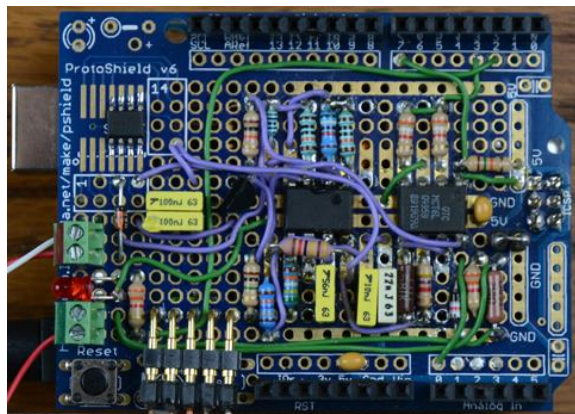
Obrázek 3 Arduino s vytvořeným převodníkem úrovní [7]
