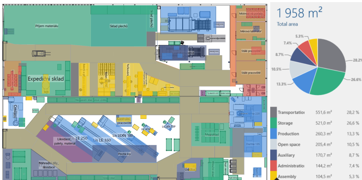
Obrázek 5-8: 2D Layout haly včetně využitých ploch - Varianta 1
