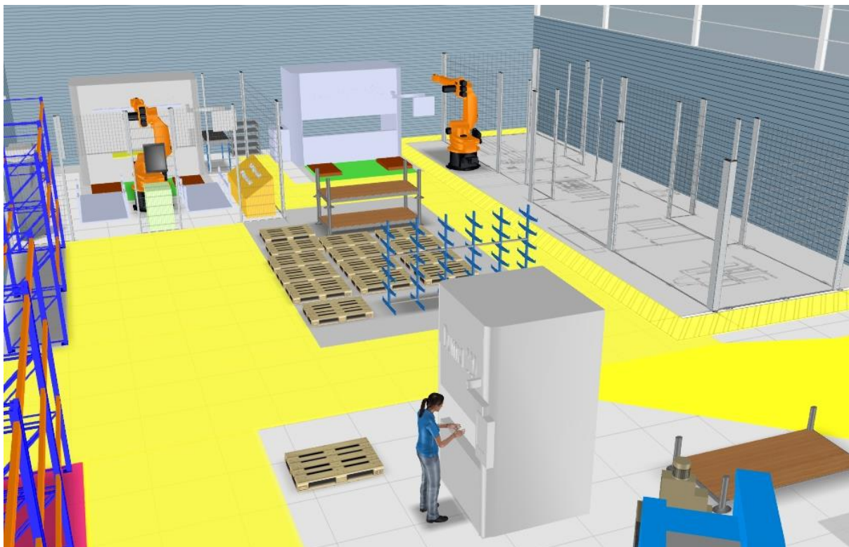
Obrázek 5-21: Implementace stroje Xpert 40 a robota u ohraňovacího lisu – Varianta 2
