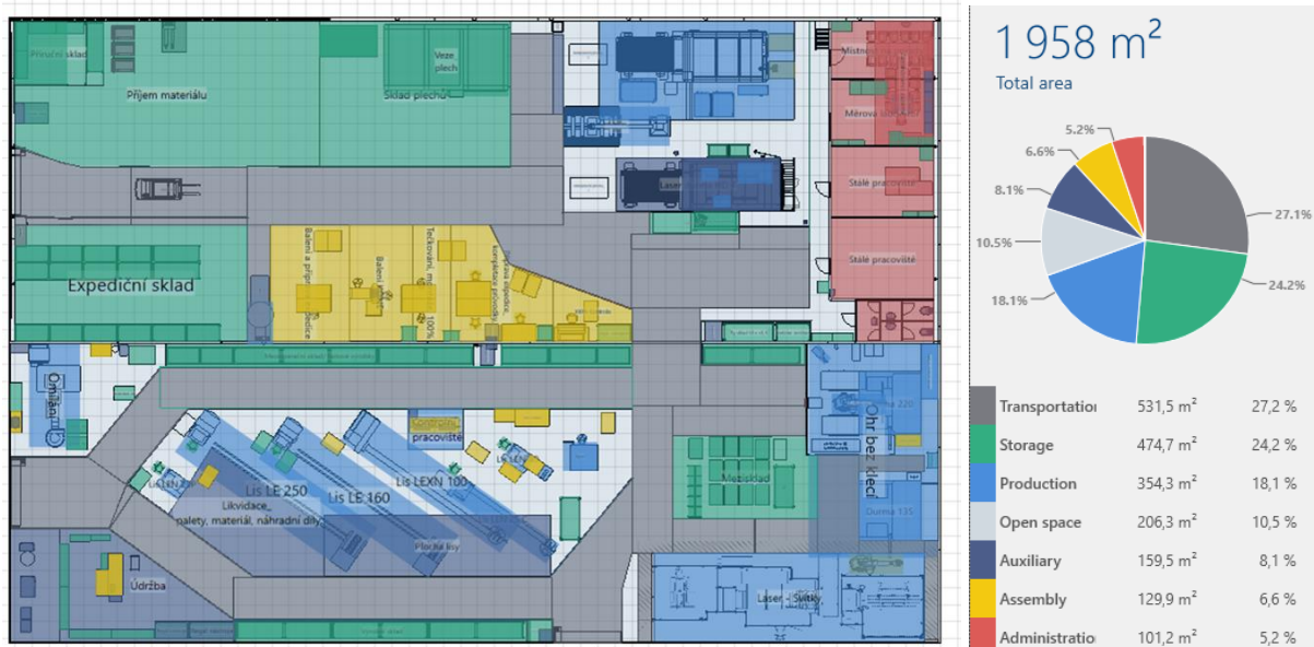
Obrázek 5-27: Layout haly včetně využitých ploch - Varianta 3
