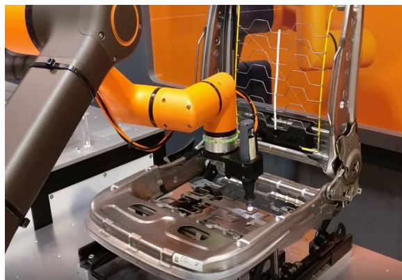
Obrázek 3-13: Leštění komponenty sedaček u aut [40]
