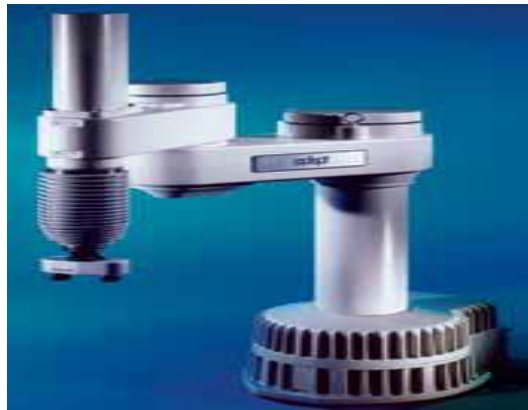
Obrázek 2-6: Robot ADEPT koncepce SCARA [24]
