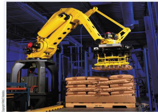
Obrázek 2-28: Robot FANUC provozovaný servomotory [33]
